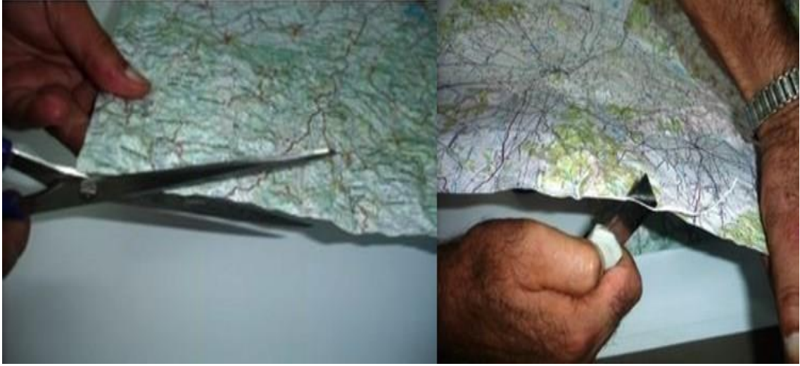
Resim 4.8 Plastik Kabartma Harita Kenarının Kesilmesi Ve Fazlalıkların Maket Bıçağı İle Alınması ( İnt. Kyn. 11 ).
