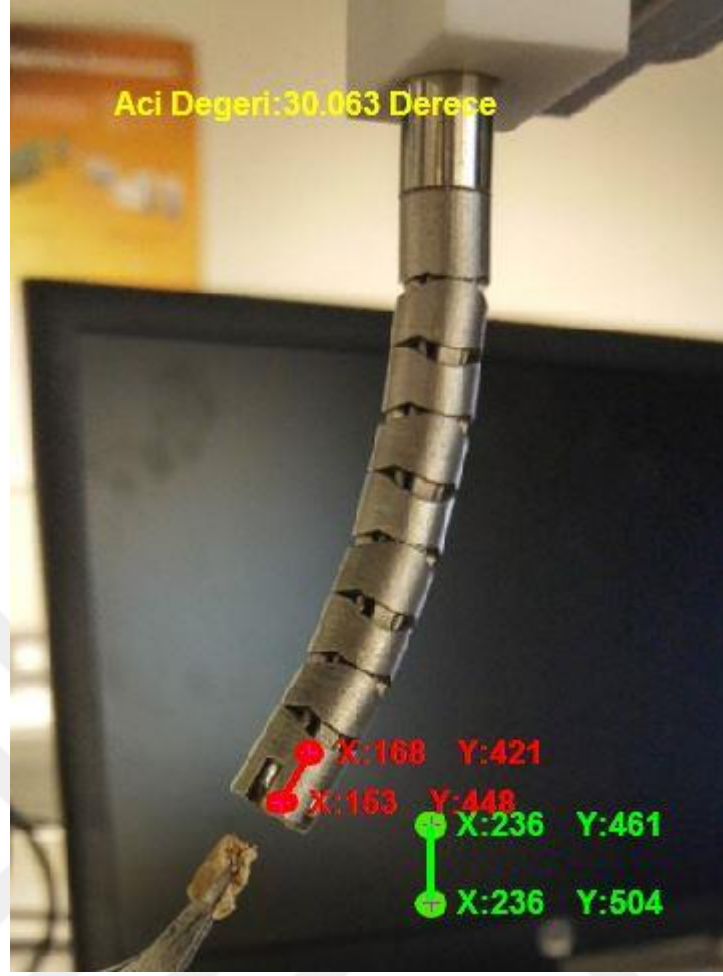
Şekil 4. 19 Görüntü işleme ile açı değeri bulunması
