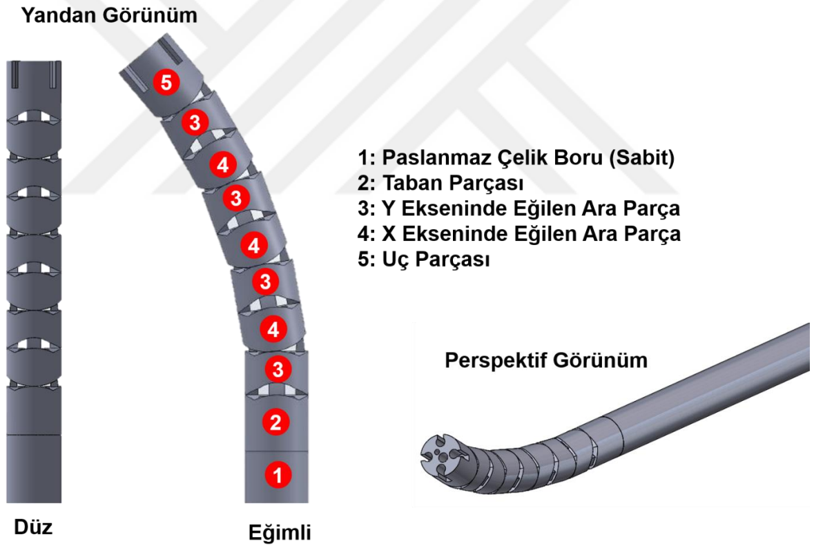
Şekil 6. 3 Eğilme mekanizmasının oluşturan parçaların birleştirilme sırası
