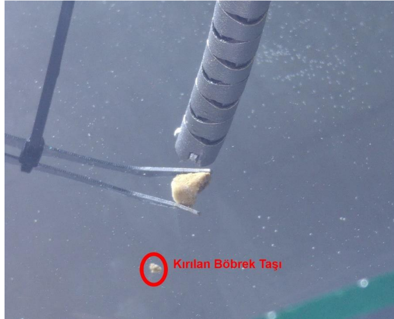
Şekil 8. 4 Deneyler sonucunda kırılan böbrek taşı
