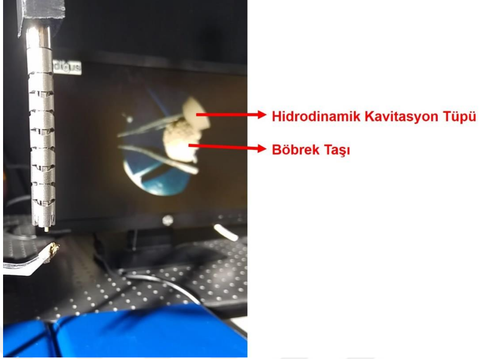
Şekil 8. 1 Eğilebilir prototip içerisindeki kameranın operatöre gösterdiği görüntü
