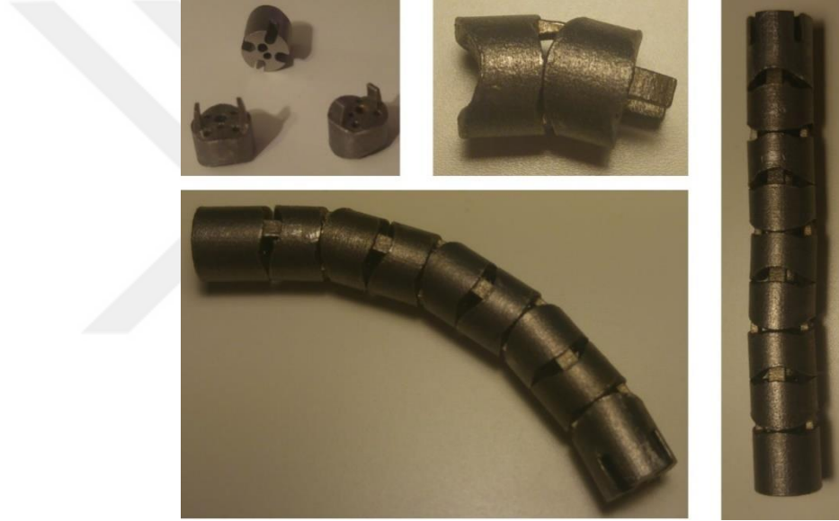
Şekil 6. 9 DMLS ile üretilen metal parçalar ve birleştirilmiş hali
