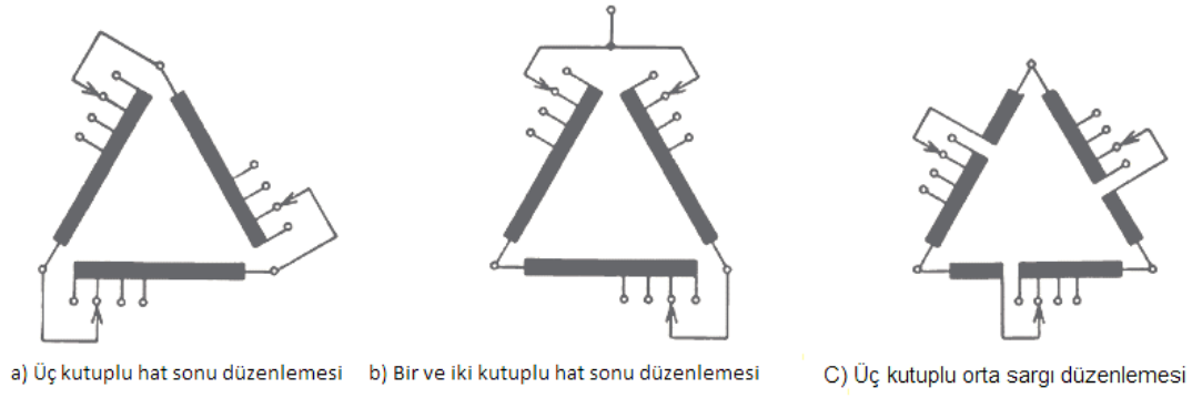
Şekil 4.13. Kademe sargıları üçgen bağlantılı yük altında kademe değiştirici [12]
