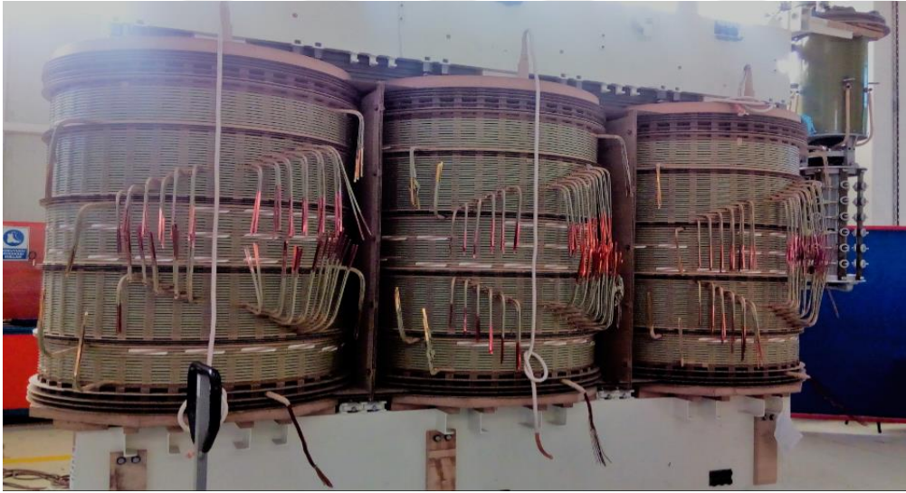
Resim 3.2. Kullanılan transformatör ve kademe değıştirici
