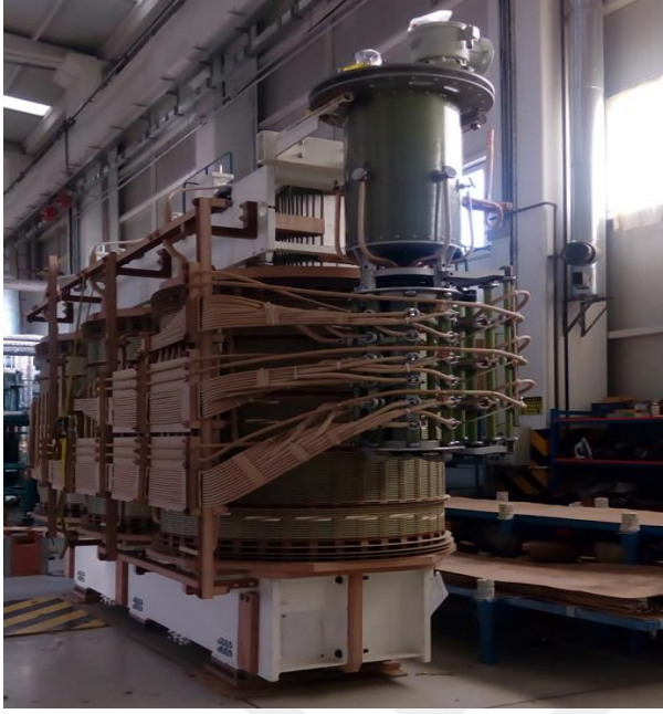
Resim 3.1. Fabrikada kullanılan yük altında kademe değıştirici sargı tipi belirlenmesi
