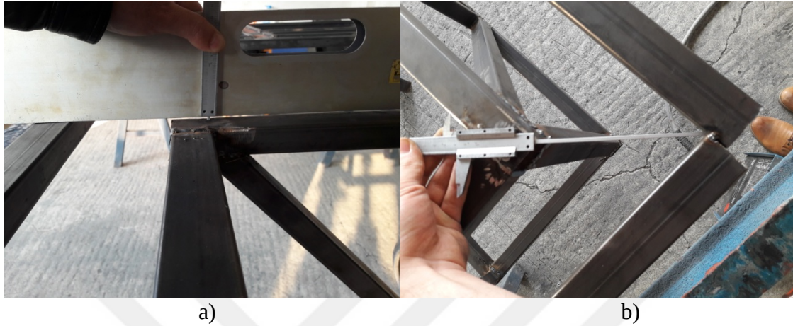
Resim 7.1. 1 numaralı kaynak dikişi için değişen ölçülerin belirlenmesi a) y ekseninden alınan ölçü b) Köşelerden alınan ölçü
