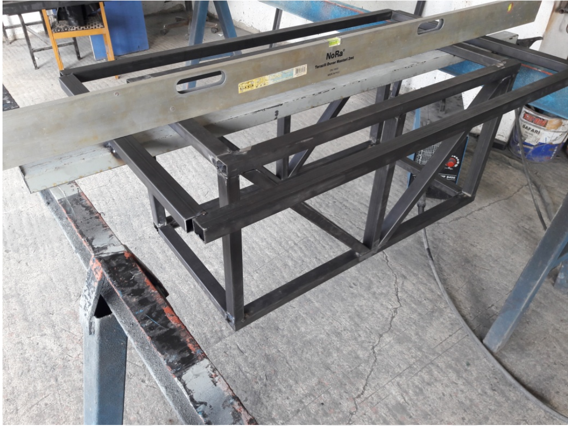
Resim 6.3. Deney düzeneğinin profillerle teraziye alınması
