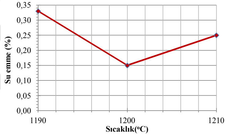
Şekil 7.9. %6 oranında \text{CeO}_2 katkılı bünyelerin sıcaklığa bağlı su emme değerleri
