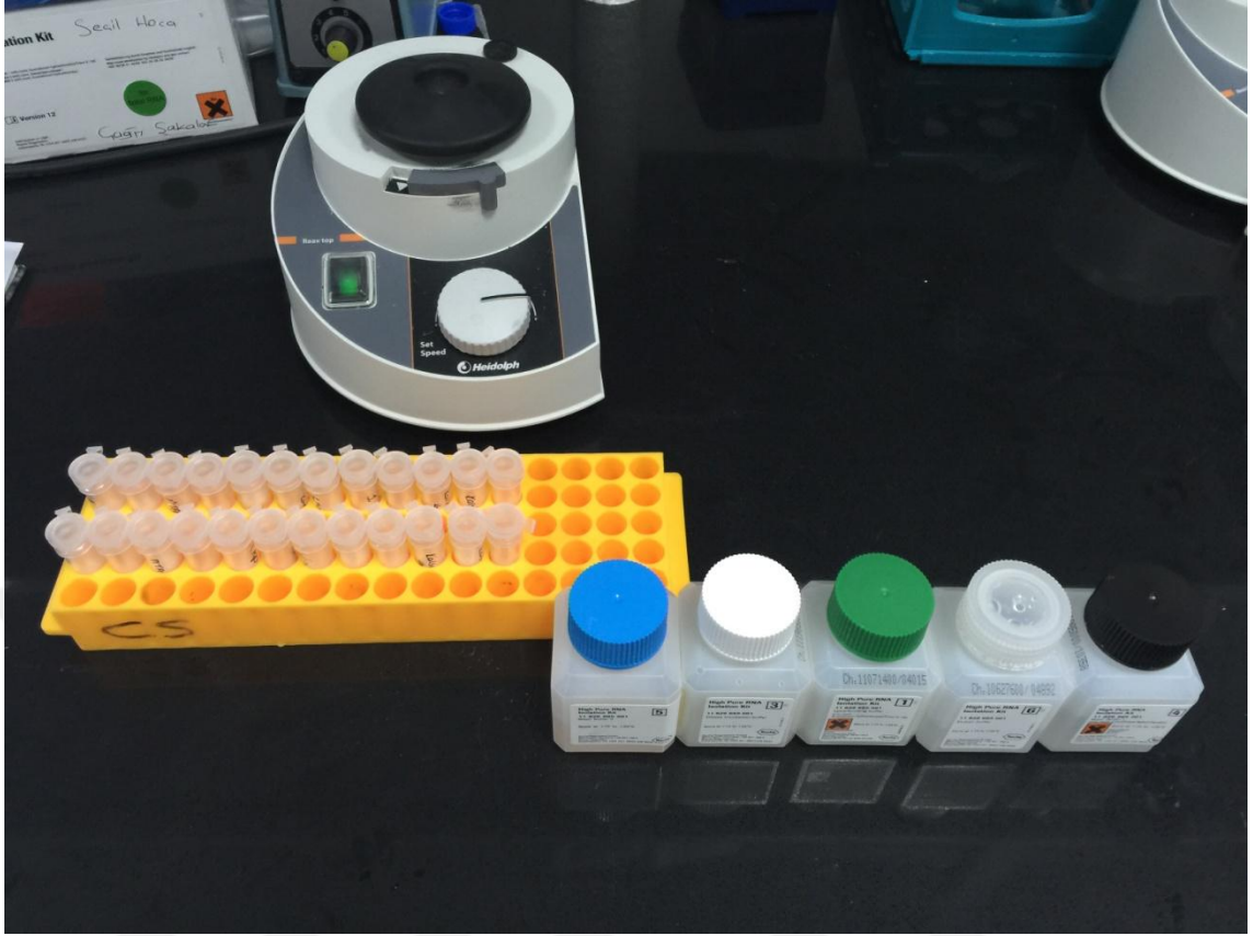
Şekil 17. Hücre pelletlerinin çözülmesi için vorteks yapılması ve RNA sentez kiti
