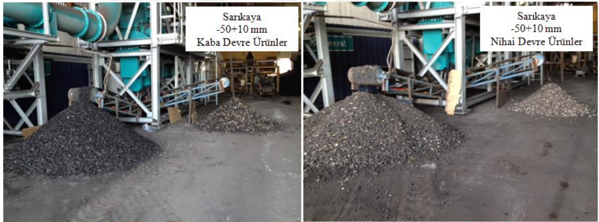
Şekil 7.2. Sarıkaya kömürü üzerinde gerçekleştirilen kuru zenginleştirme sonrasında elde edilen ürünler.
