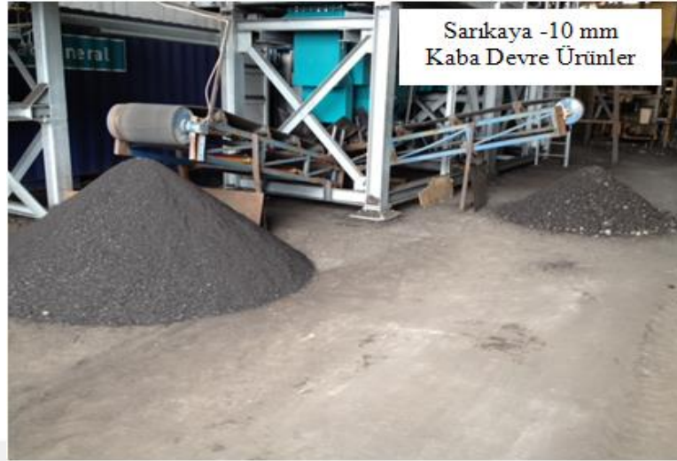
Şekil 7.3. Sarıkaya kömürü üzerinde gerçekleştirilen kuru zenginleştirme sonrasında elde edilen ürünler.
