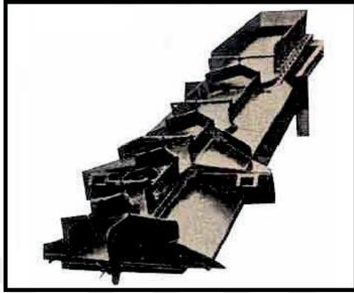
Şekil 3.2. Pnömatik osilasyonlu havalı masa (Donnelly 1999).
