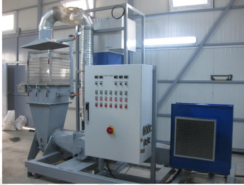
Şekil 4.22. Kesikli çalışan Allair Jig (-50 mm).
