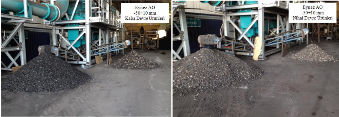
Şekil 7.4. Eynez açık ocak (AO) kömürü üzerinde gerçekleştirilen kuru zenginleştirme sonrasında elde edilen ürünler.
