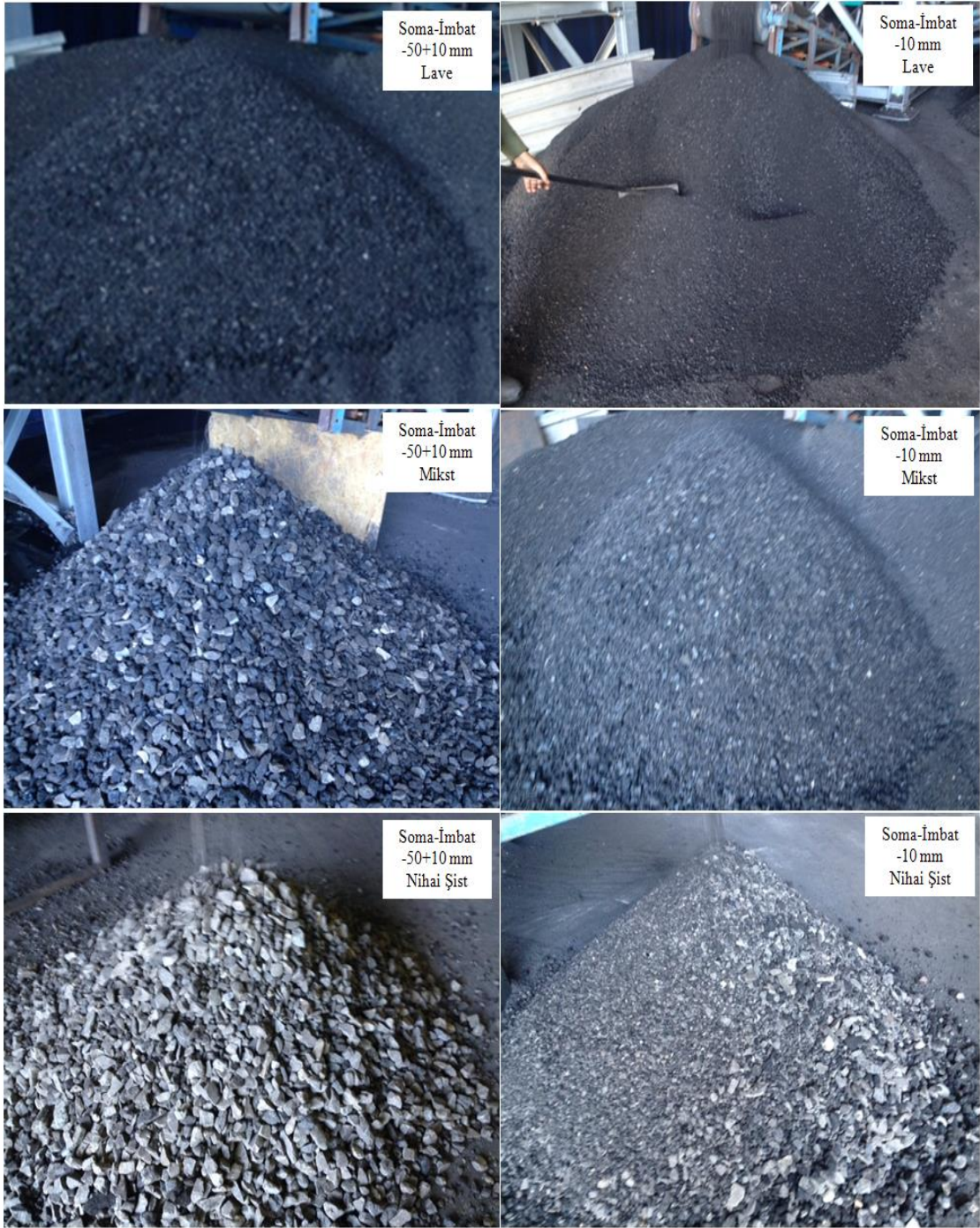
Şekil 7.1. Soma-İmbat kömürü üzerinde -50+10 mm ve -10 mm boyut grublarında gerçekleştirilen kuru zenginleştirme sonrasında elde edilen ürünler.
