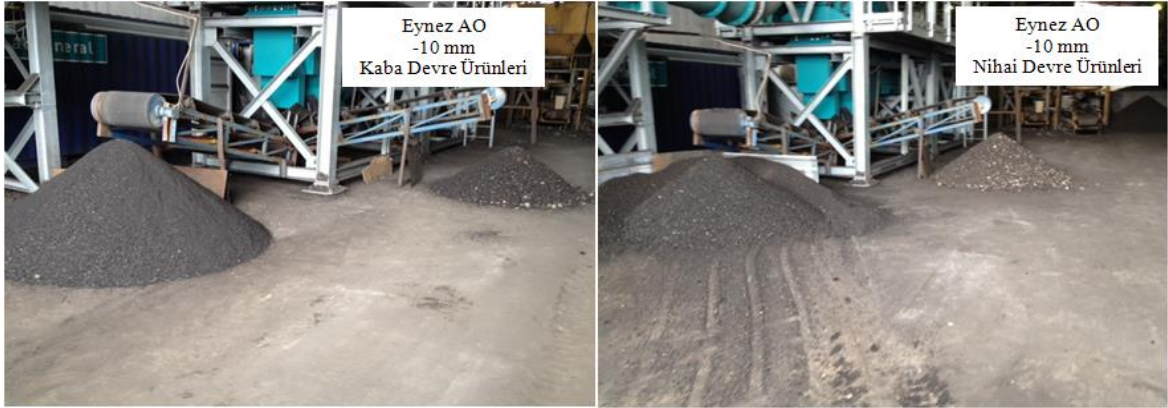
Şekil 7.5. Eynez açık ocak (AO) kömürü üzerinde gerçekleştirilen kuru zenginleştirme sonrasında elde edilen ürünler.
