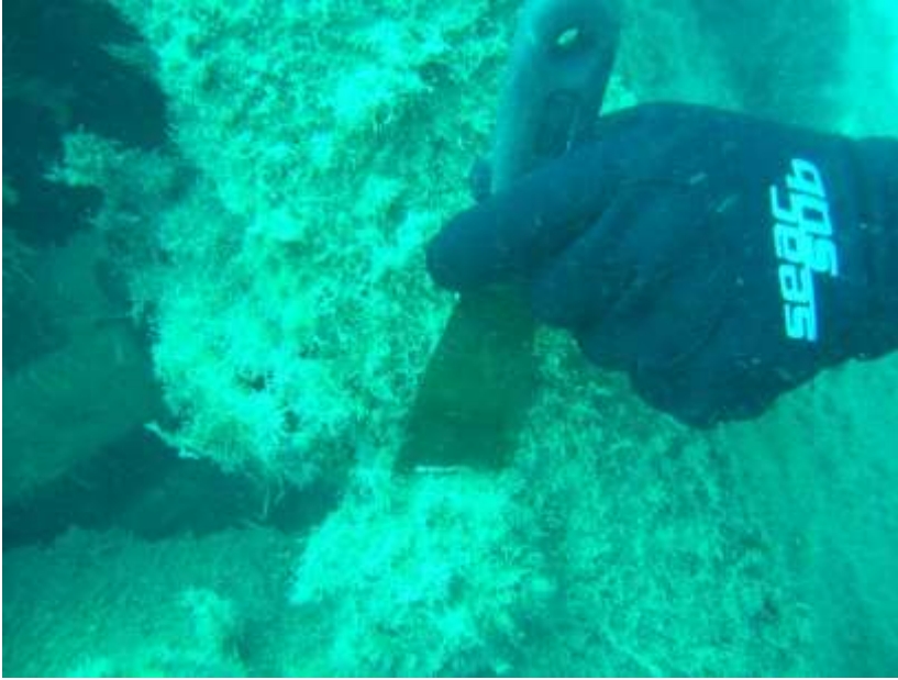
Şekil 27 Spatula yardımıyla örneklerin resif bloğu üzerinden kazınması
