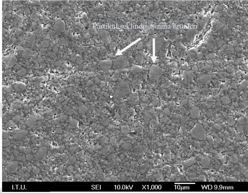
Şekil 4.11. Fırçalama sonrasında reçine nano seramiğin (Lava™ Ultimate) SEM görüntüsü (X1000)
