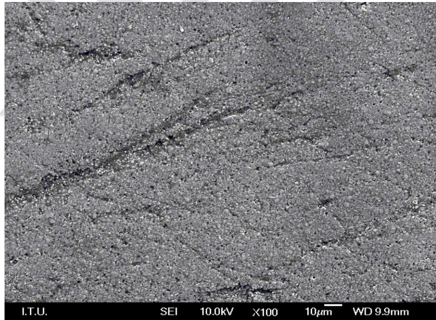
Şekil 4.18. Fırçalama sonrasında kompozit reçinenin (Paradigm MZ100) SEM görüntüsü (X100)
