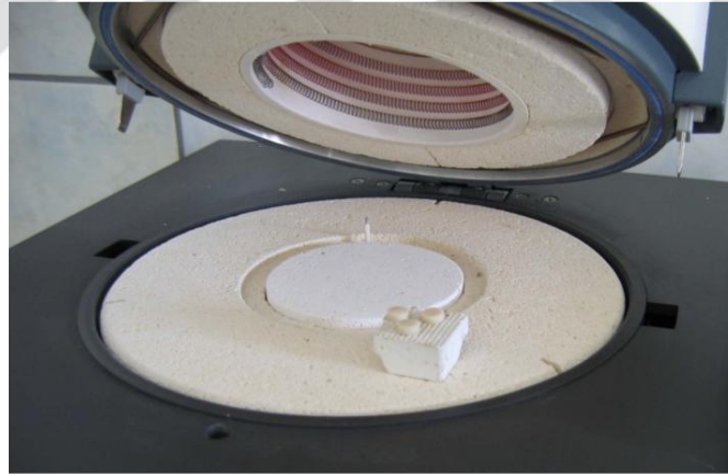
Şekil 3.9. Glazür uygulaması ve IPS Progromat P90 seramik fırını
