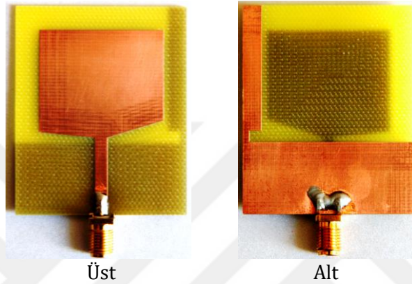
Şekil 4.16. Üretimi gerçekleştirilen monopol anten
