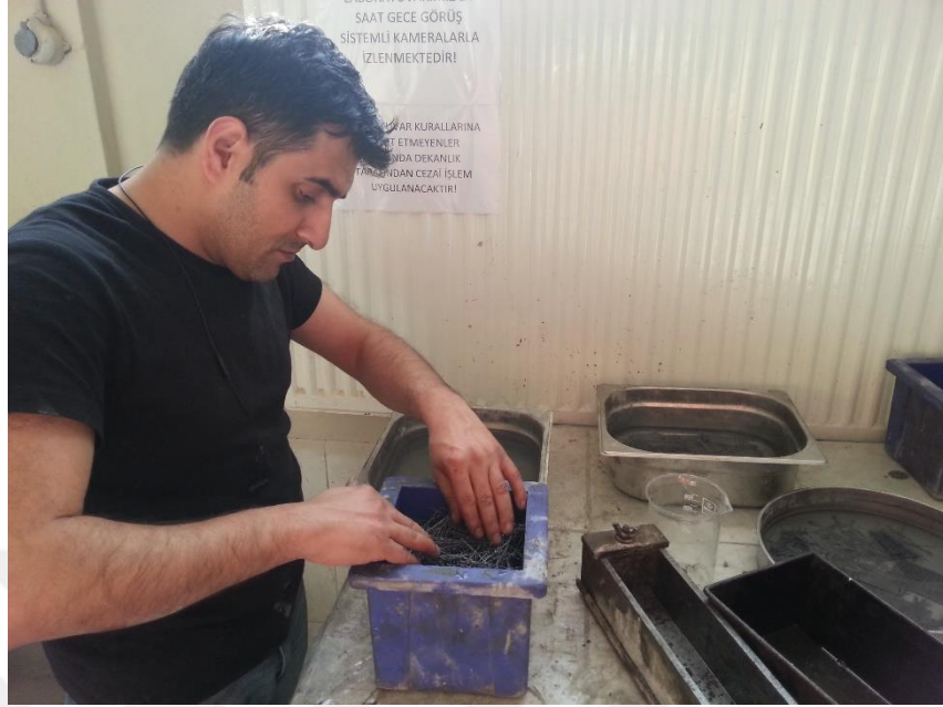
Şekil 3.7. Çelik liflerin önceden kalıba yerleştirilmesi
