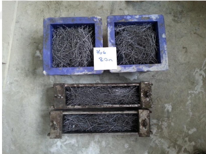
Şekil 3.8. Kalıba yerleştirilmiş çelik lifler
