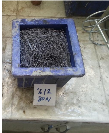
Şekil 4.4. Küp numune için hazırlanmış %12 lif oranında ve 80 narinlikteki çelik lifler
