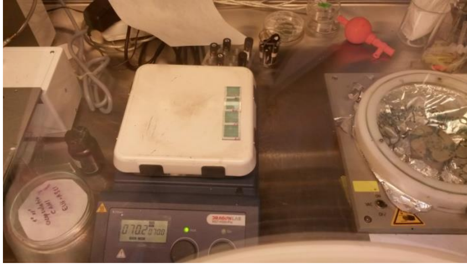
Şekil 2.16: Isıtıcı yüzey üzerinde çözücü buharlaştırma işlemi.
