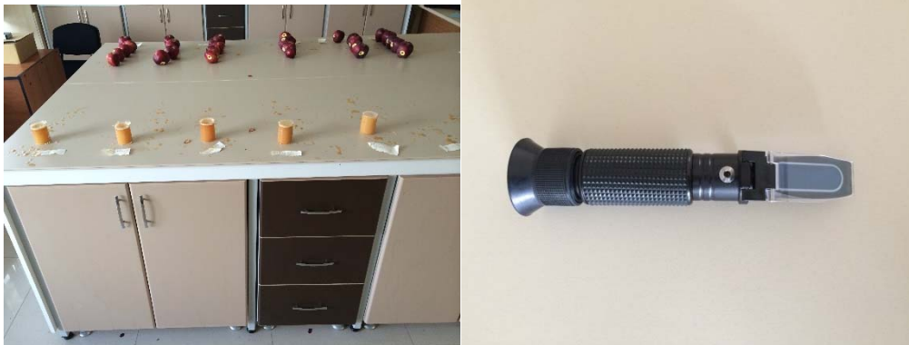
Şekil 3.11. Meyve suyunda SÇKM ölçümü
