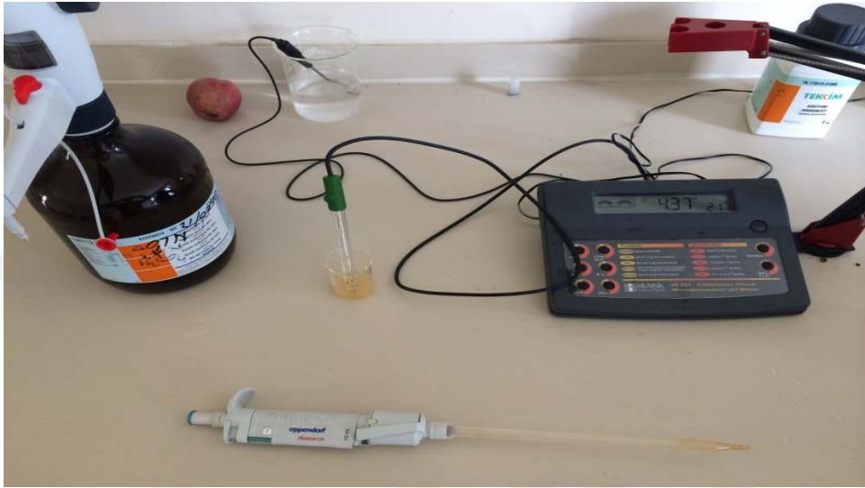
Şekil 3.12. Titre edilebilir asitlik miktarı ölçümü
