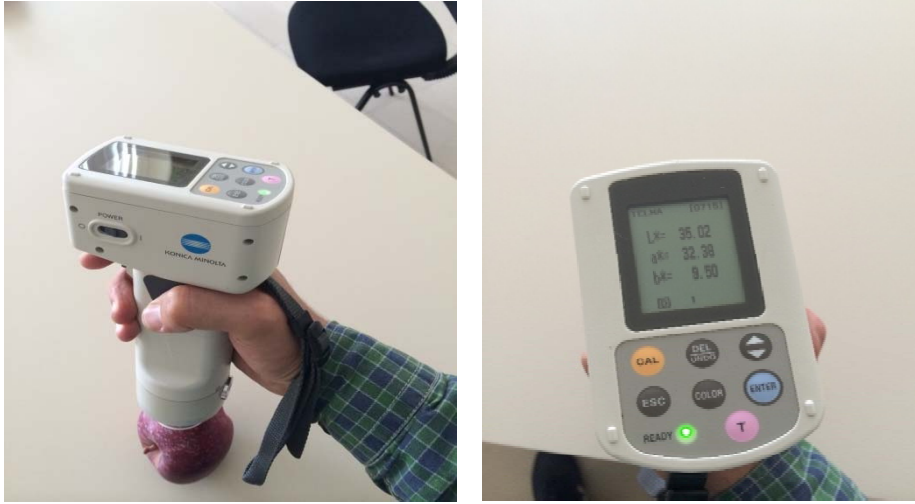
Şekil 3.10. Meyve kabuk rengi ölçümü
