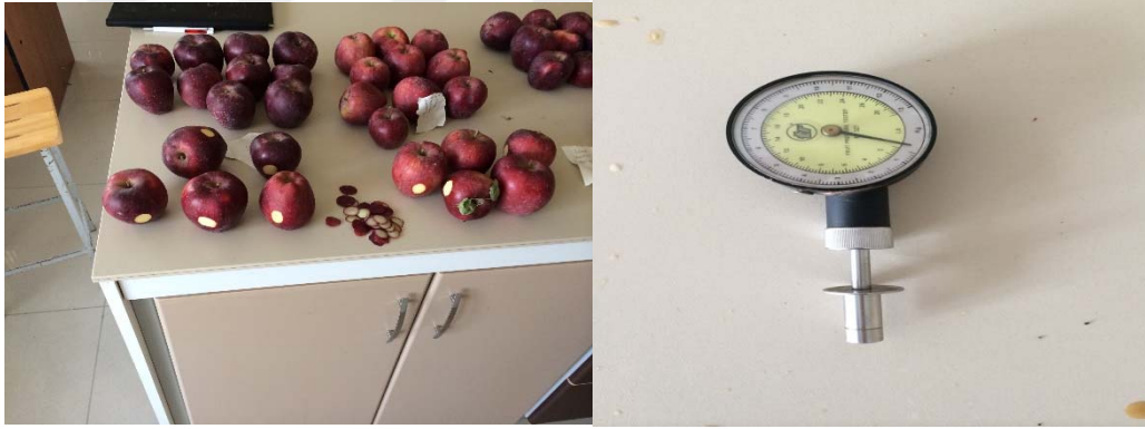
Şekil 3.9. Penetrometre ile meyve eti sertliği ölçümü
