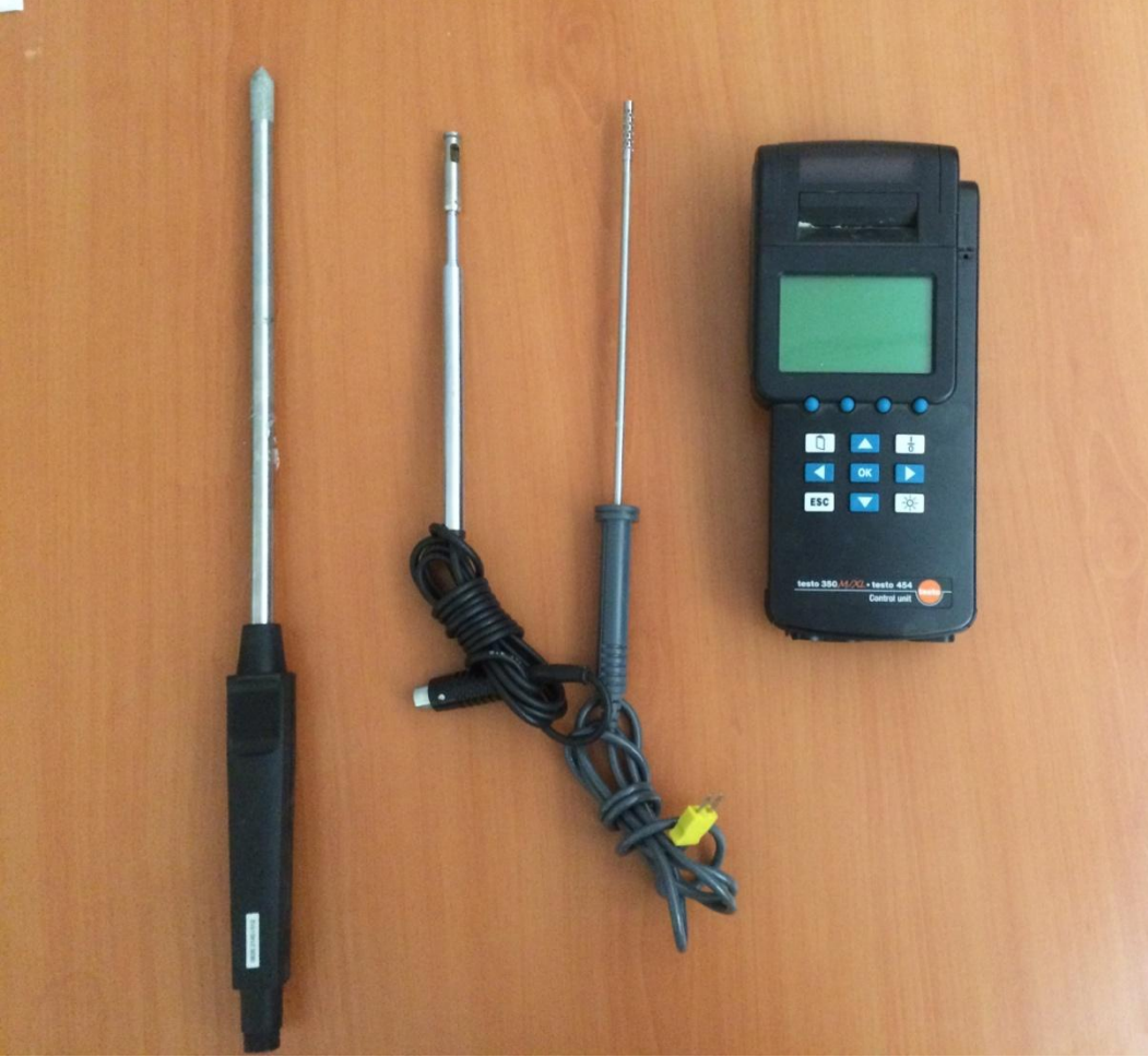
Şekil 4.3. Ölçüm cihazı ve problarının görselleri 1) Nem probu 2) Hız ölçüm probu 3) K tipi termocouple 4) Testo 454 datalogger
