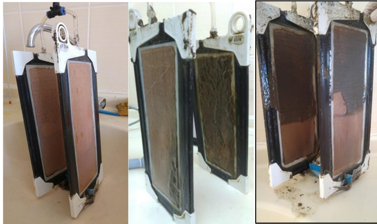
Şekil 3.80. UF modülünde çeşitli tıkanma görüntüleri
