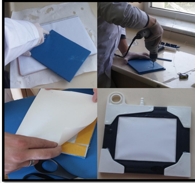
Şekil 2.6. Membran modülünün hazırlanışı
