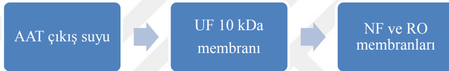
Şekil 2.10. AAT çıkış suyu için uygulama prosedürü (UF 10 kDa)
