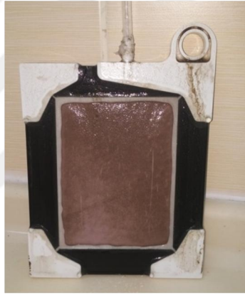
Şekil 3.74. MBR işletimi sonrası membran modülünden bir görünüm
