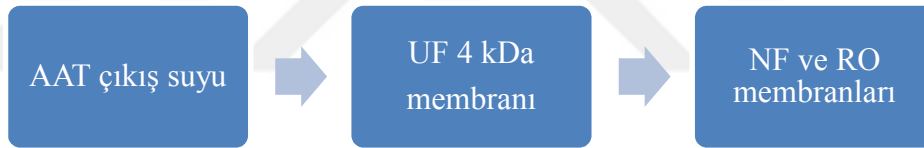
Şekil 2.11. AAT çıkış suyu için uygulama prosedürü (UF 4 kDa)
