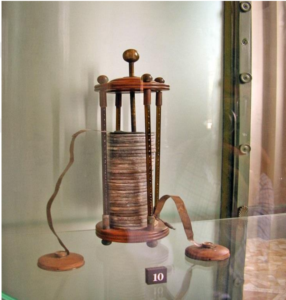
Şekil 2.2. Volta Pili [URL 2]
