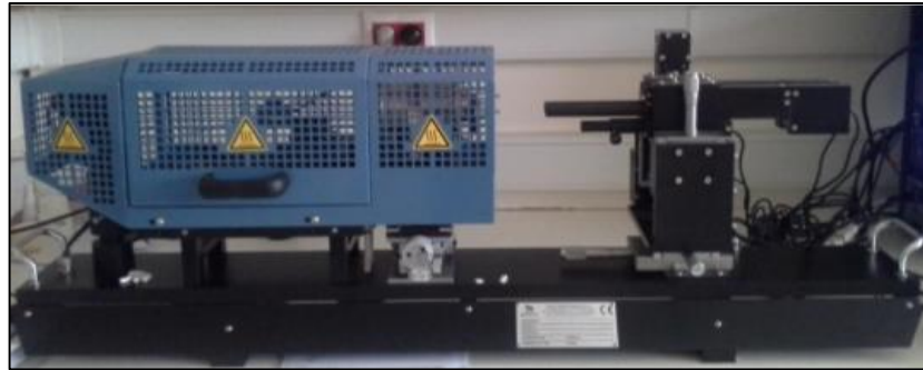
Şekil 3.6: Misura 3 ODHT optik dilatometre ve ısı mikroskobu cihazı.
