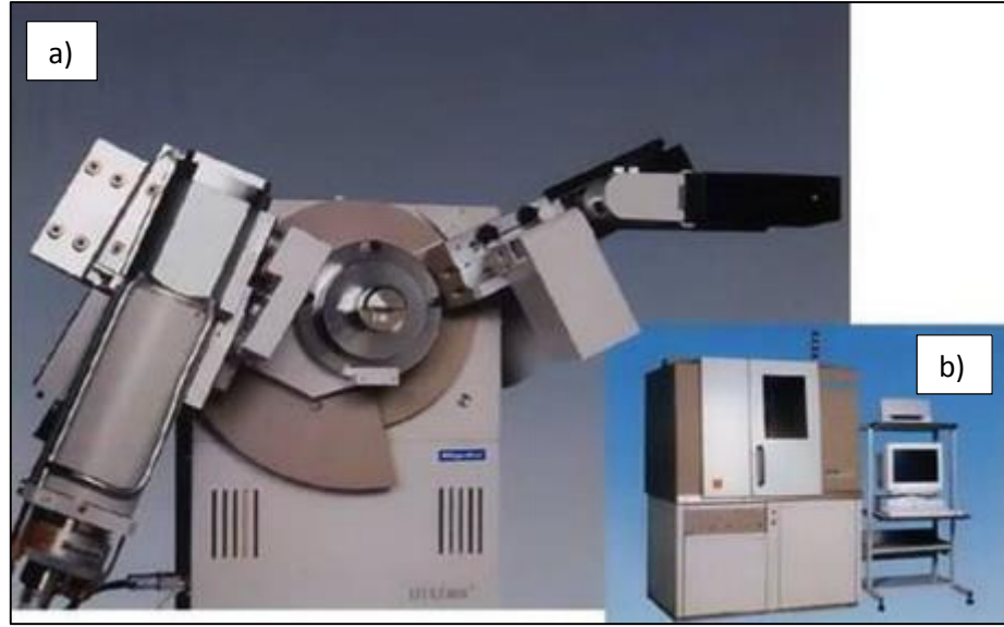
Şekil 3.14: a) Rigaku D-max 2200 serisi difraktometre, b) XRD cihazı.
