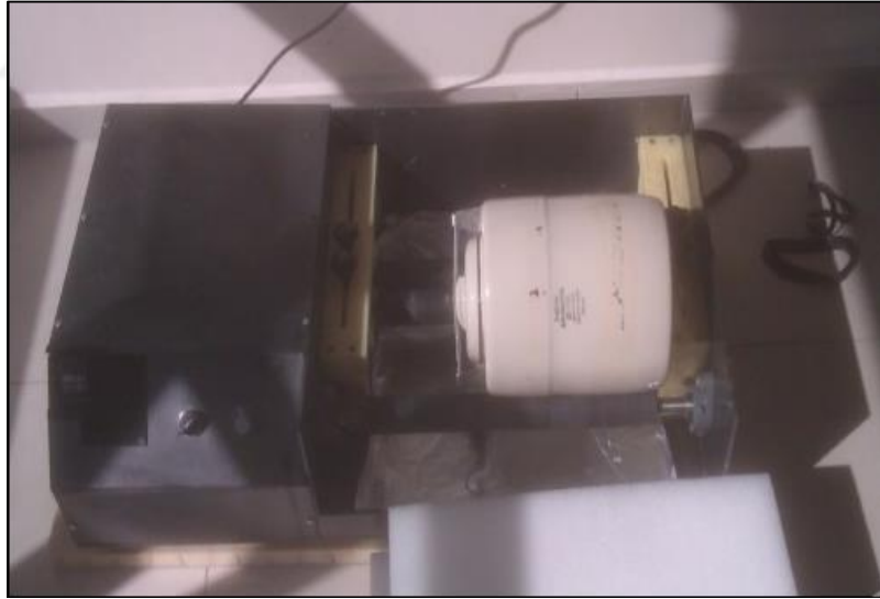
Şekil 3.1: Bilyalı değirmen kabı ve düzeneği.
