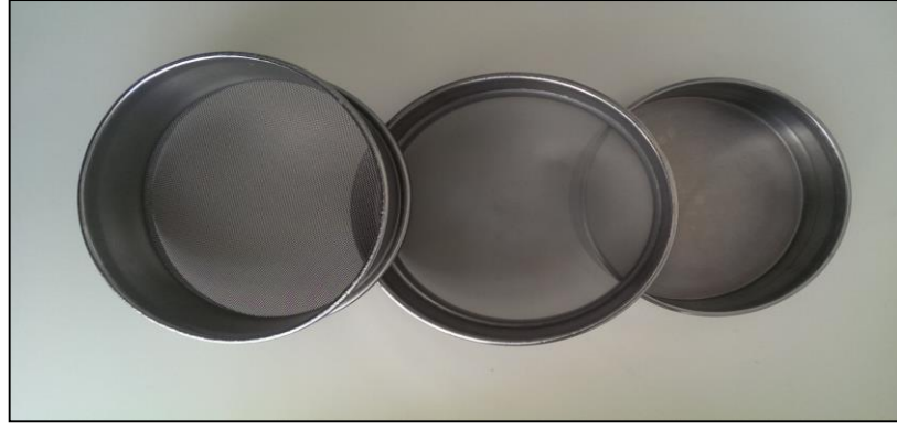
Şekil 3.4: Granülleme işleminde kullanılan elekler.
