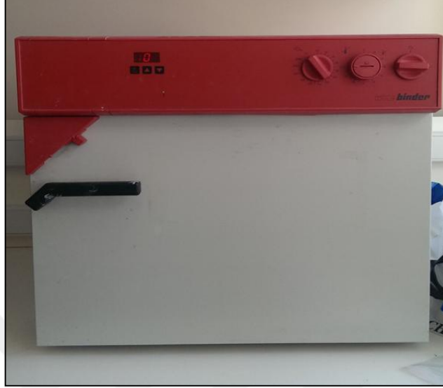
Şekil 3.3: WTC Binder marka kurutucu etüv.
