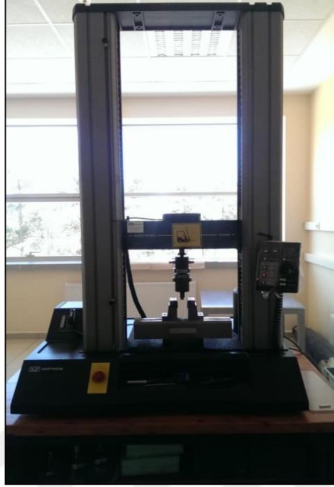
Şekil 3.9: 5569 Model instron cihazı ve üç nokta eğme düzeneği.
