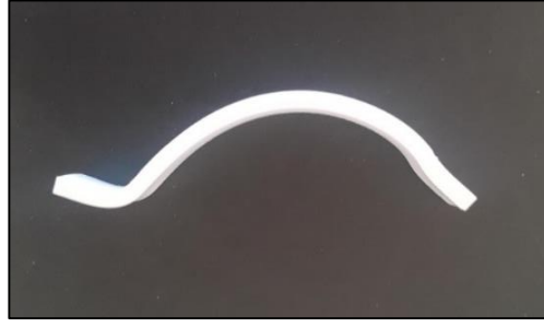
Şekil 3.11: Bone china numunelerinin sinterlenmesi sırasında açığa çıkan deformasyon.
