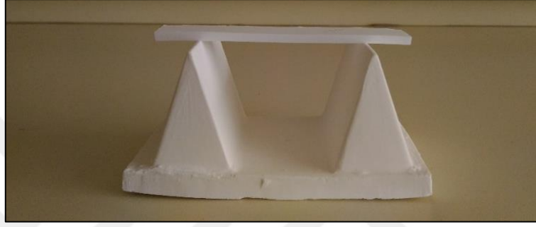
Şekil 4.14: Sinterleme öncesi deformasyon mekanizması.
