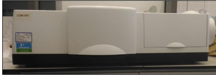
Şekil 3.13: Perkinelmer lambda 950 marka ışık geçirgenlik cihazı.
