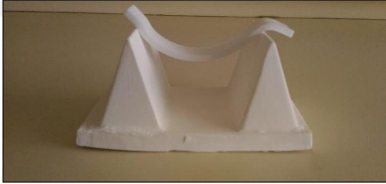
Şekil 4.15: Sinterleme sonrası deformasyon mekanizması.
