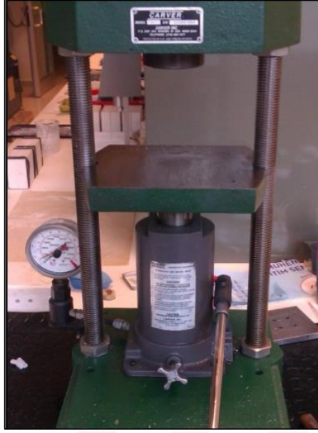
Şekil 3.5: Carver hidrolik pres makinesi.
