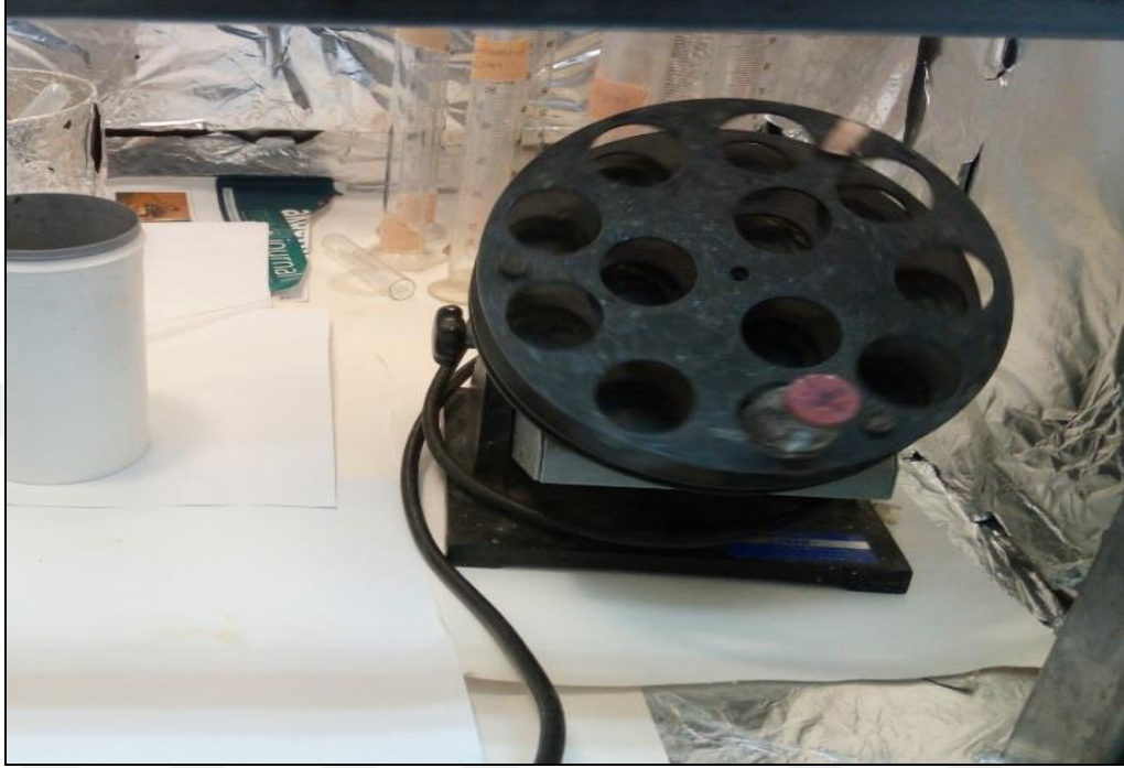
Şekil 2.7: Parazit örneklerinin RT rotatorda bekletilme aşaması
