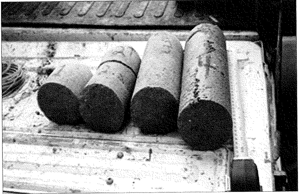
Şekil 4.10. Jet grout kolondan alınan numuneler
