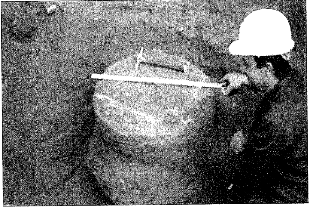
Şekil 4.8. Bir test jet grout kolonunun incelemesi
