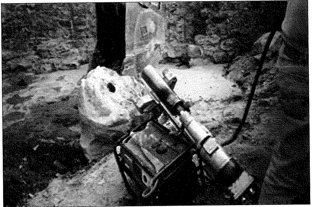
Şekil 4.9. Test kolonunun karot numune işlemi
