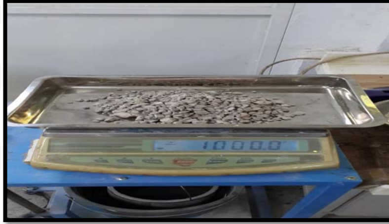
Şekil 3.6. Özgöl ağırlık deneyi için RAP malzemesinin ekstraksiyon kalıntısı iri agregaların tartılması.
