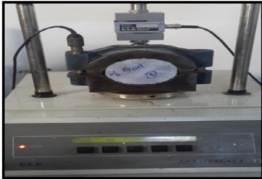
Şekil 3.16. Marshall deneyi uygulanma aşamaları
