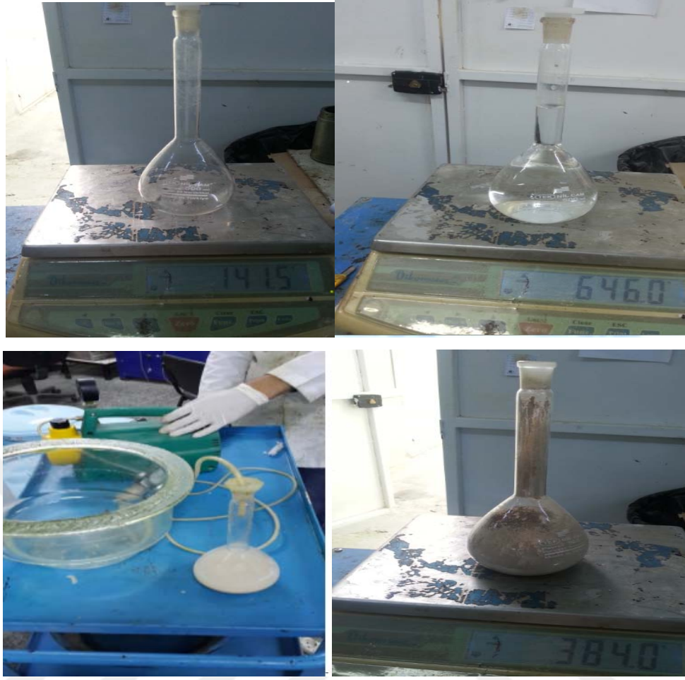
Şekil 3.9. Mineral filler için zahiri özgül ağırlık deney adımları.
