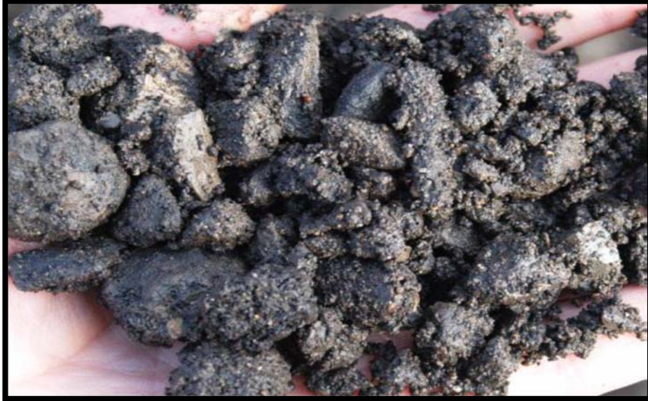
Şekil 1.12. Kaba RAP malzemesi(NAPA,2011)
