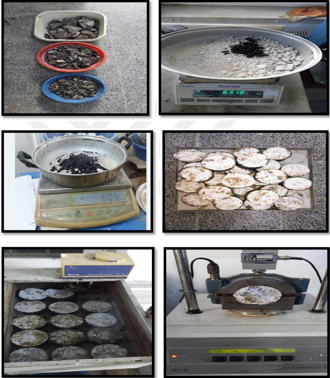
Şekil 3.17. RAP malzemesi kullanılan Marshall briket numuneleri hazırlanmasının aşamaları
