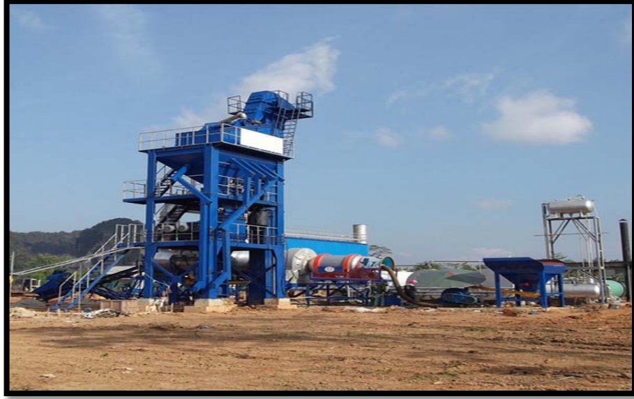
Şekil 1.1. Bir asfalt geri dönüşüm santrali (Anonim 1)
