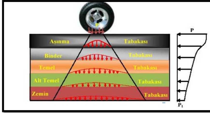
Şekil 1.2. Tipik bir yol üstyapı kesiti ve gerilme dağılımı (Çetin, 2007)
