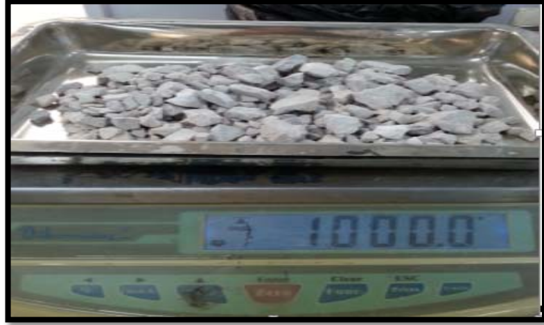
Şekil 3.5. Özgöl ağırlık deneyi için normal iri agregaların tartılması.
