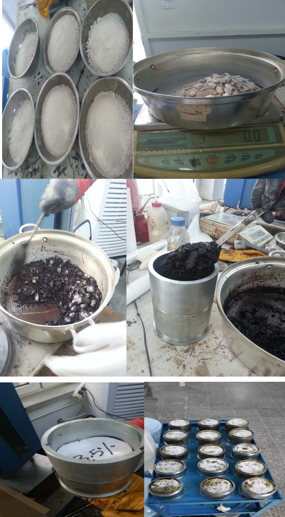
Şekil 3.14. Marshall briket numuneleri hazırlanmasının aşamaları
