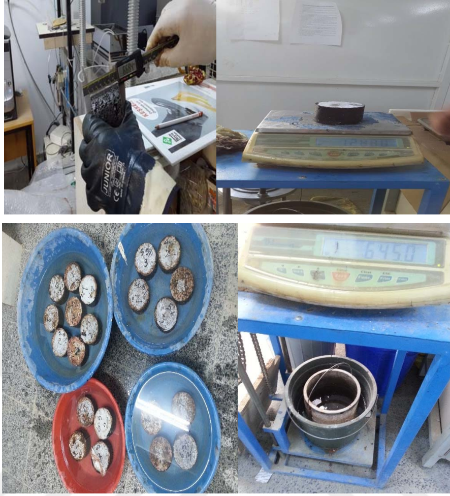
Şekil 3.15. Marshall deneyi uygulanma aşamaları
