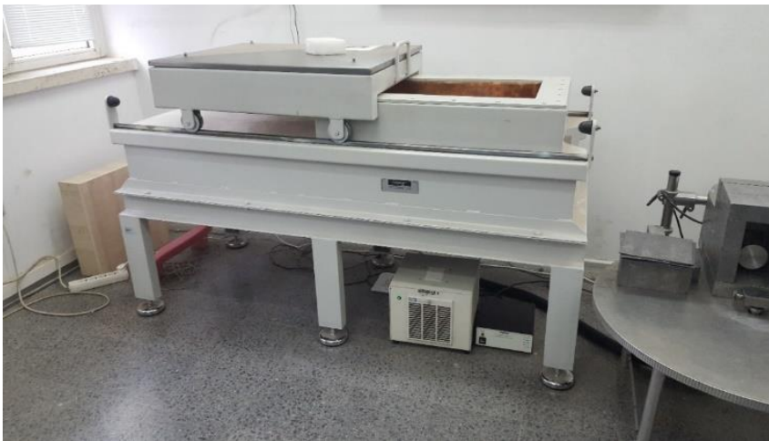
Şekil 3.4. Akdeniz Üniversitesi Nükleer Bilimler Uygulama ve Araştırma Merkezi’nde bulunan ORTEC marka HPGe dedektör sistemi
