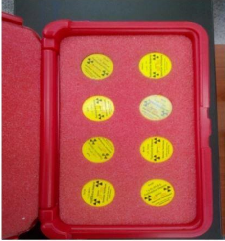
Şekil 3.5. HPGe dedektörün kalibrasyonu için kullanılan radyoaktif kaynaklar
