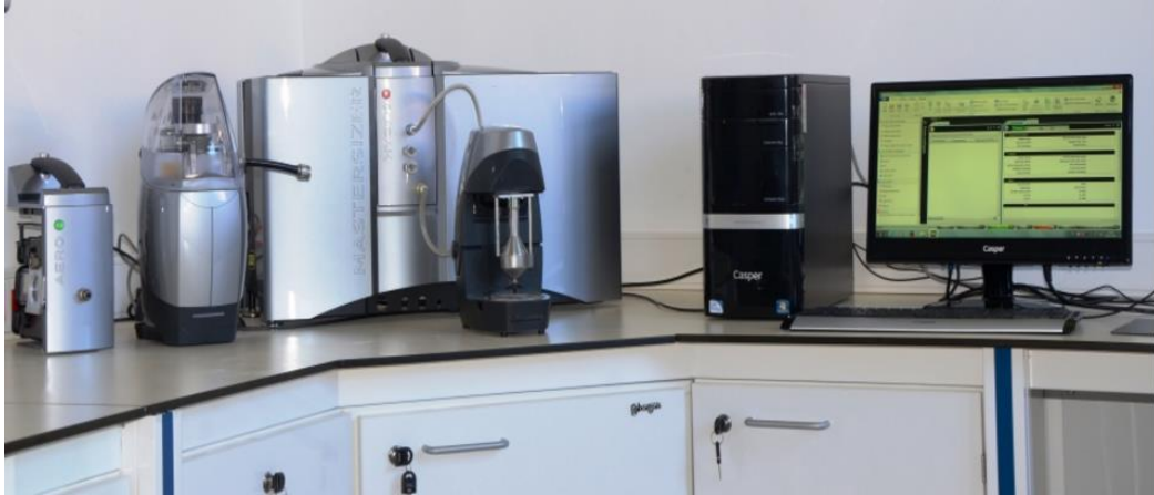
Şekil 3.12. Malvern marka tane boyut dağılımı ölçüm cihazı.
