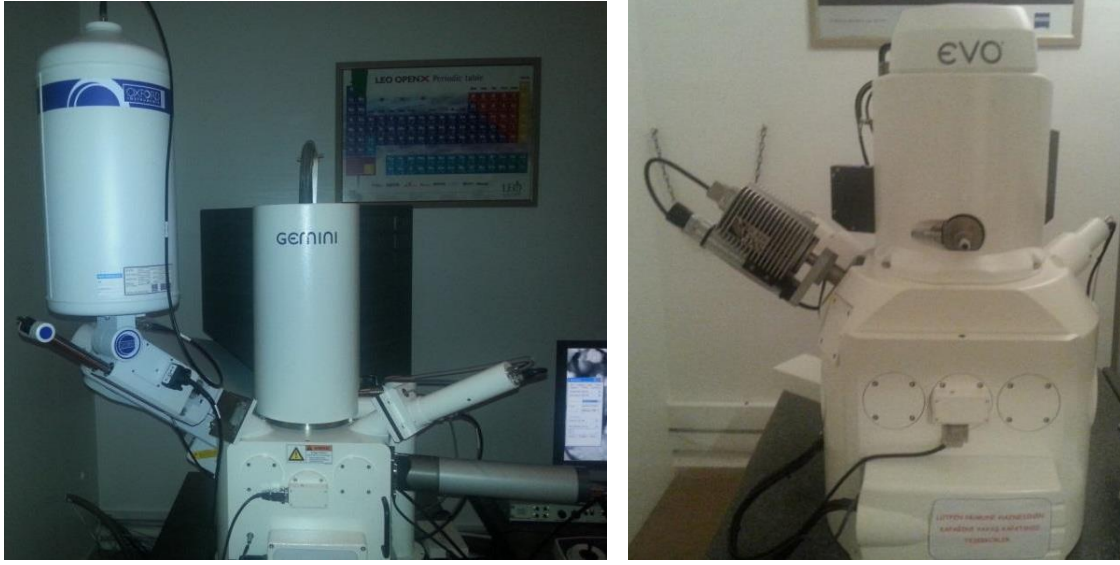
Şekil 3.15. Soldan sağa ZEISS Supra 50 VP ve ZEISS Evo 50 EP SEM cihazları.
