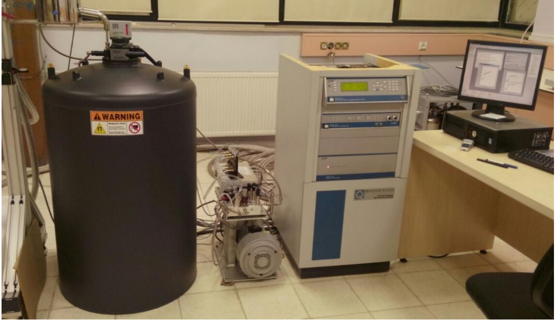
Şekil 3.20. Quantum Design PPMS 9T cihazı.
