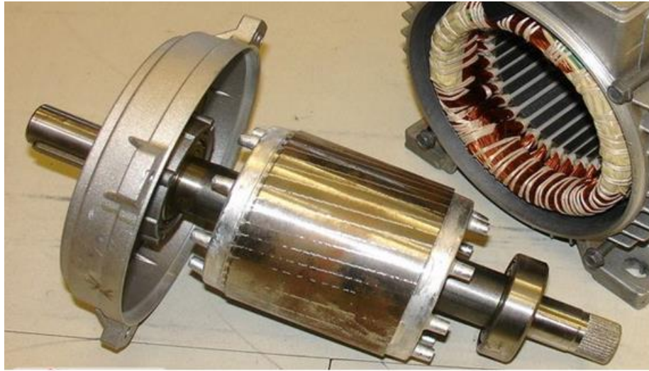
Şekil 1.11. Elektriği güçlü dönme hareketine çeviren motor görüntüsü ( https://en.wikipedia.org/wiki/Electric_motor ).
