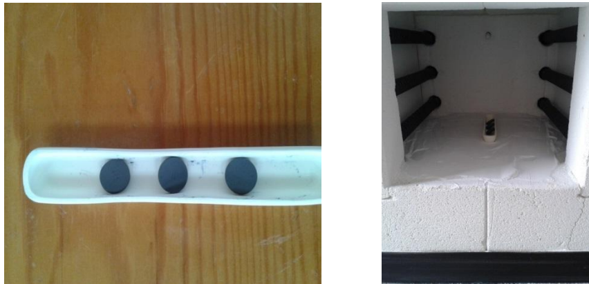
Şekil 3.6. Örneklerin şekli ve fırına yerleşim düzeni.
