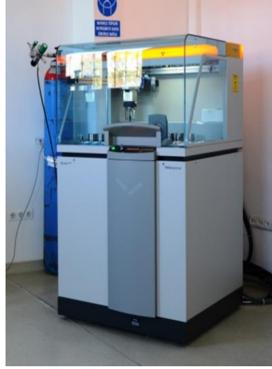
Şekil 3.1. PANalytical - AXIOS XRF cihazı.
