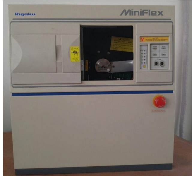
Şekil 3.2. Rigaku Miniflex marka XRD cihazı.
