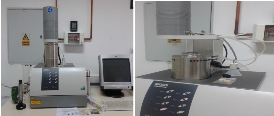
Şekil 3.17. Termal iletkenlik ve termal difüzivite ölçümlerinde kullanılan LFA 457 cihazı.
