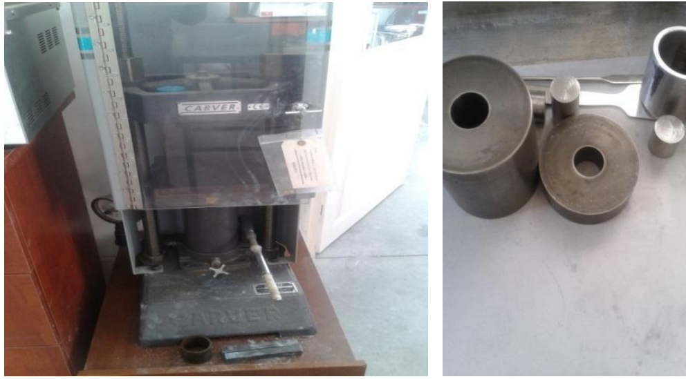
řekil 3.14. Pelet örnekler için kullanılan Carver marka hidrolik pres ve kalıplar.
