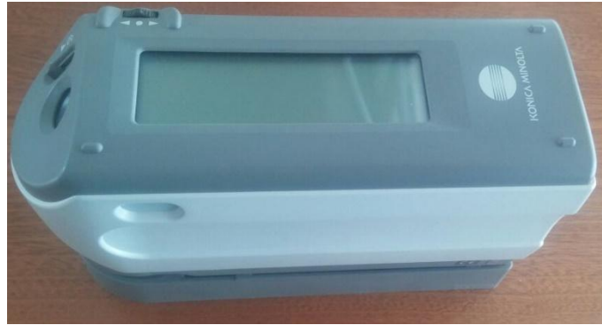
Şekil 3.22. Çalışmada kullanılan Konika Minolta 3600d spektrofotometre.
