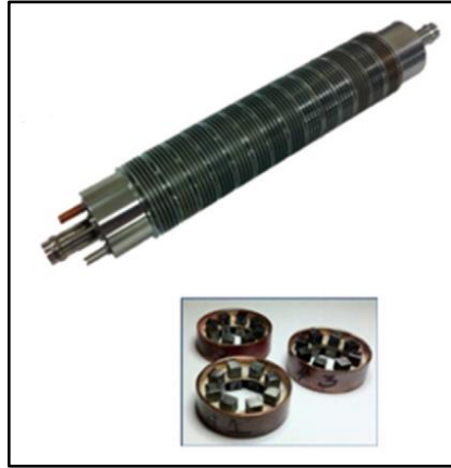
Şekil 1.3. Gentherm firması tarafından yapılan silindirik termoelektrik jeneratör (Leblanc, 2014; https://www.google.com/patents/US20130186448 ).
