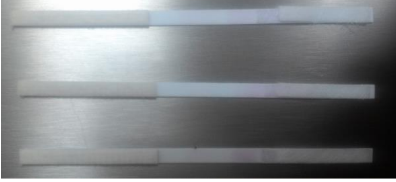
Şekil 3.15 Bloklama solüsyonu 2 ile hazırlanan kit.
