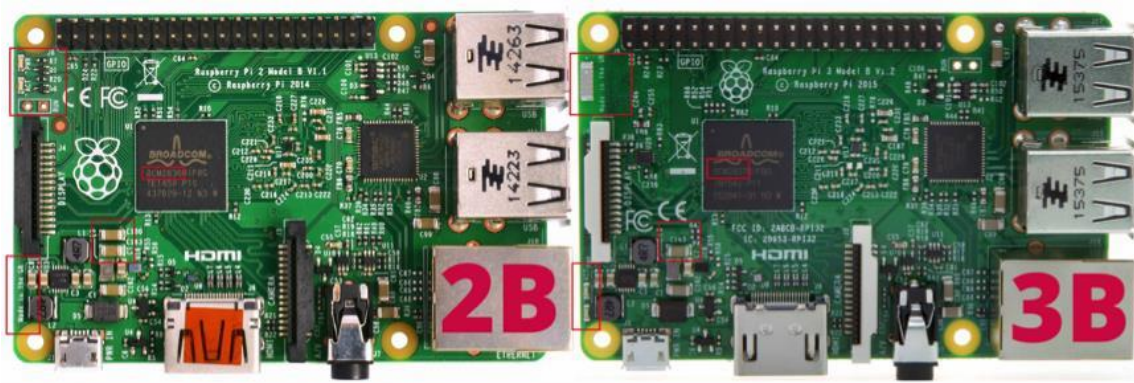
Şekil 3.3: Raspberry Pi 2 ile Raspberry Pi 3 arasındaki Görsel Farklar
