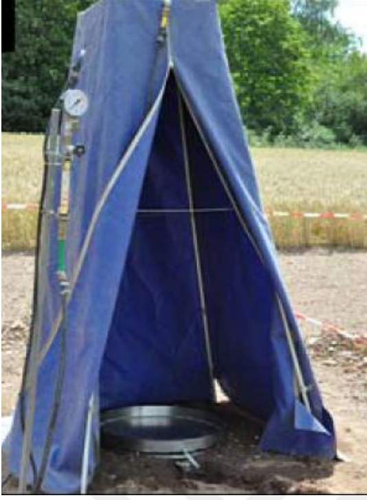
Fotoğraf 2.1. Yapay yağış simülatörü (a) ve (b) (Iserloh vd., 2013)
