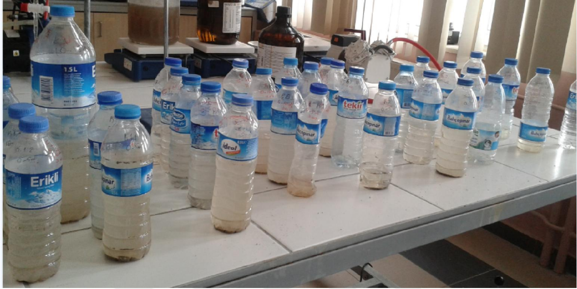
Fotoğraf 4.3. Yapay yağış uygulaması sonrası toplanan yüzeysel akış örnekleri
