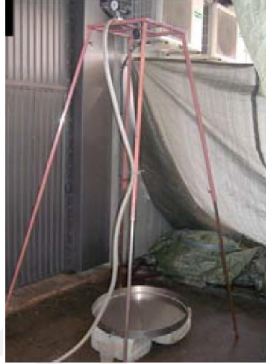
Fotoğraf 2.1. Yapay yağış simülatörü (a) ve (b) (Iserloh vd., 2013)
