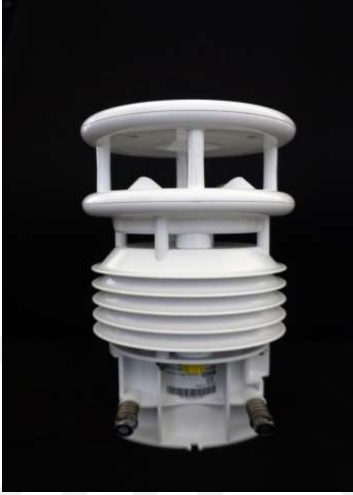
Şekil 2.3. Rüzgar hız-yön, sıcaklık, basınç ve nem algılayıcısı
