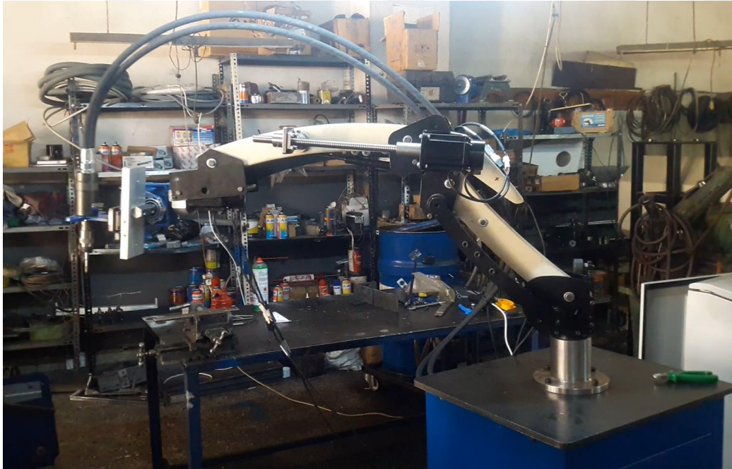
Resim 1.7. Kılavuz çekme makinası prototipi hedef noktaya ulaşması esnasında bir görüntü
