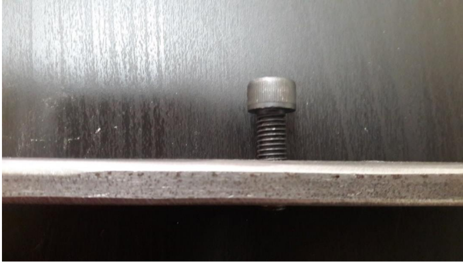
Resim 4.7. Kılavuz çekme makinası ile vida diři açılan test parçasının uygun vida ile denenmesi yandan görünümü
