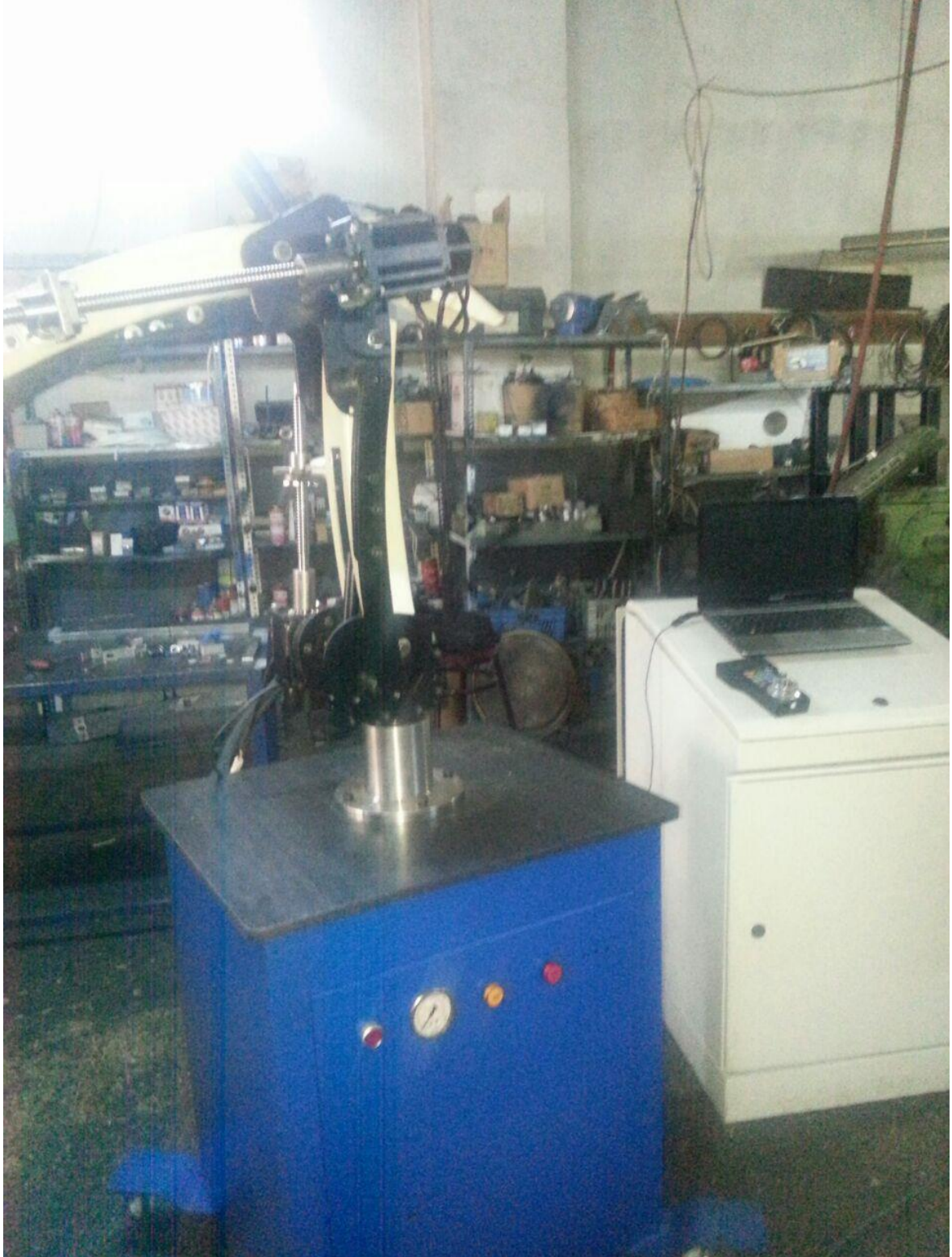
Resim 1.5. Kılavuz çekme makinası kontrol panosu, kablosuz el çarkı ve manipülâtör gövdesi
