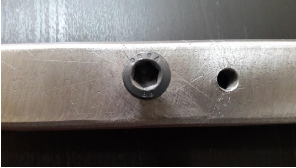
Resim 4.6. Kılavuz çekme makinası ile vida diři açılan test parçasının uygun vida ile denenmesi
