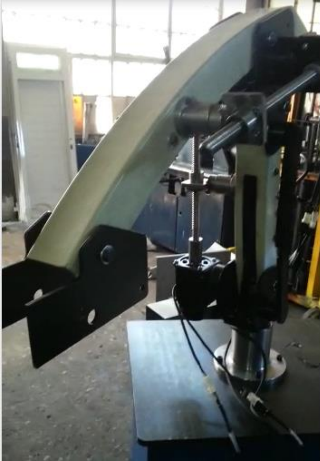
Resim 1.4. Kılavuz çekme makinası imalat aşaması uç işlevci eklenmeden önceki halinden bir kesit
