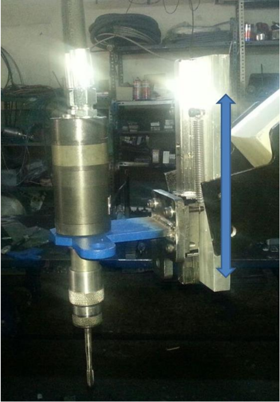
Resim 4.5. Uç işlevcinin kayar kızağa yay ile bağlanmasından kaynaklanan salınımlı hareketi
