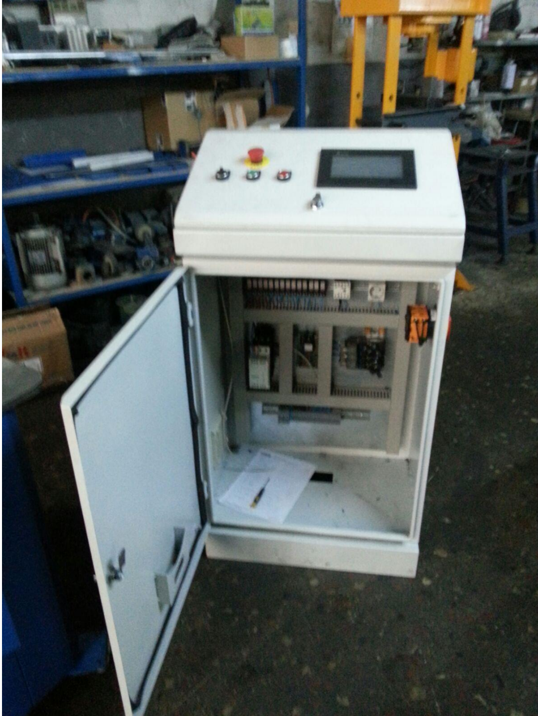
Resim 1.1. Kılavuz çekme makinası kontrol panosu
