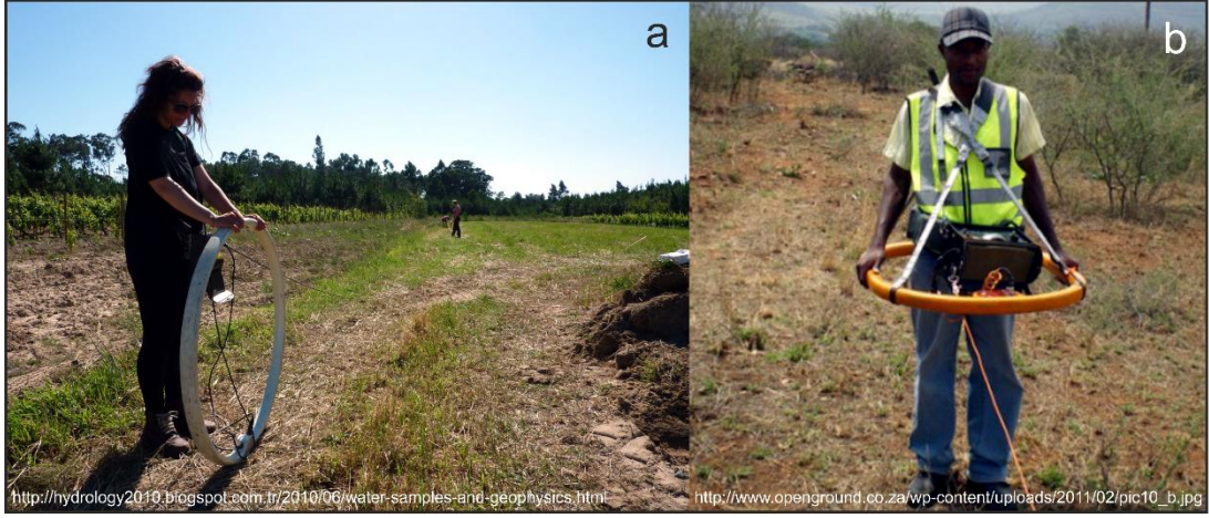
Şekil 4.4. (a) Düşey ve (b) Yatay eş düzlemlı halkalar kullanılarak gerçekleştirilen YHEM ölçümlerinden bazı görüntüler
