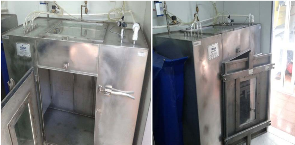
Şekil 3.5. Kontrollü atmosfer kabin görünüşleri
