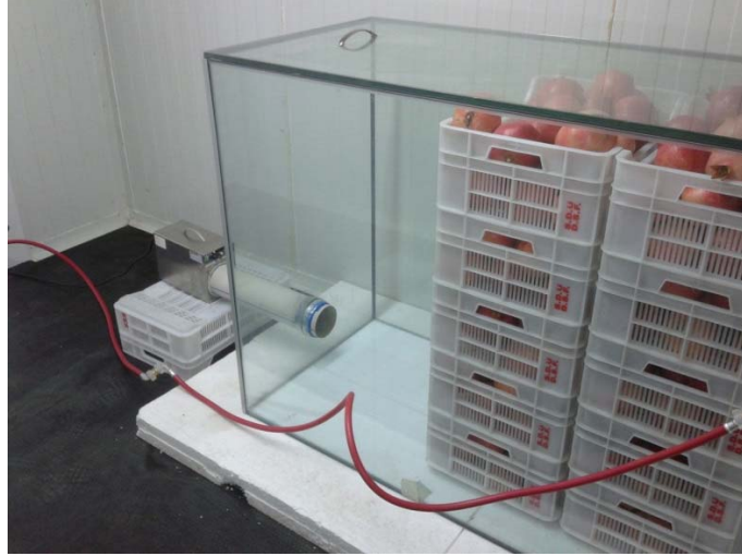
Şekil 3.4. Denemede kullanılan meyvelere ozon gazı uygulaması
