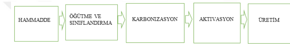
Şekil 4.6. Fiziksel aktivasyon yöntemiyle aktif karbon üretim akım şeması
