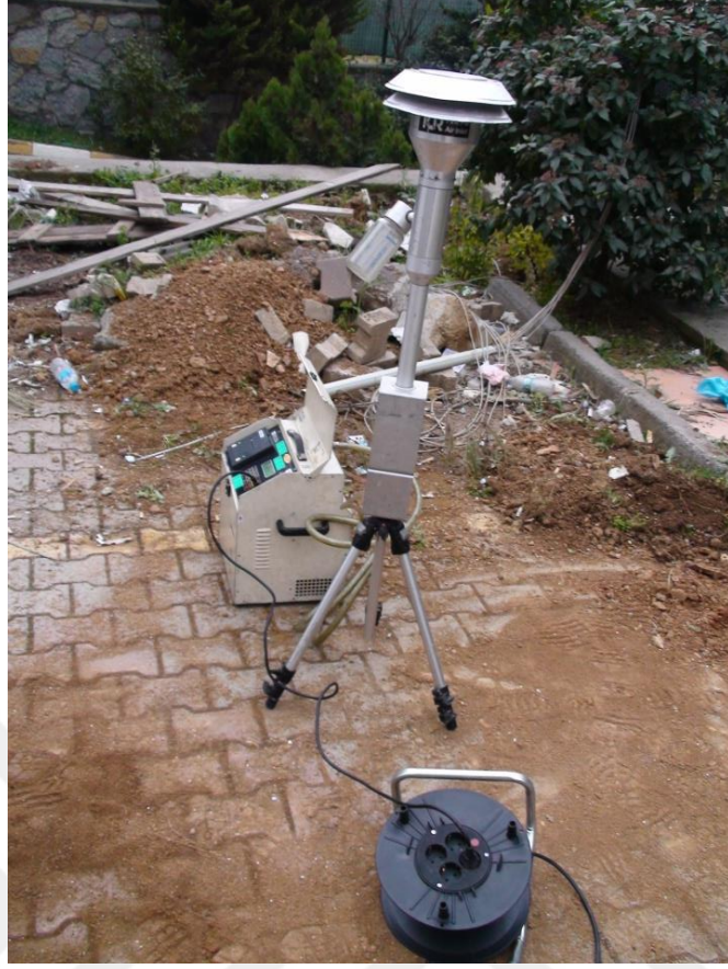
Şekil 4.66. Toz Ölçümlerinde Kullanılan Cihazın Kontrollü Patlatmadan Önce Çalışma Sahasındaki Görünümü
