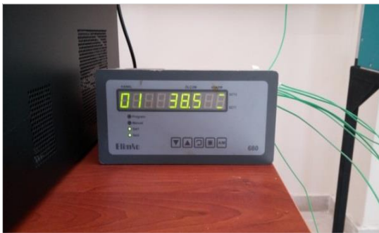
Resim 3.10. ELIMKO E-680 tipi veri kaydedici (datalogger)
