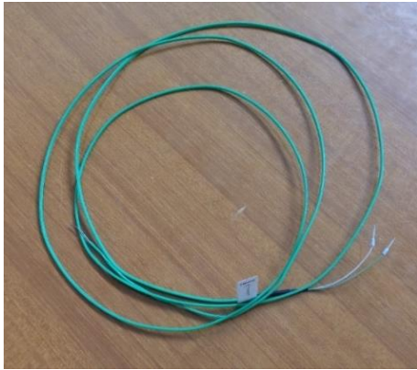
Resim 3.5. E-TC15-K-K30-TT ürün kodlu K tipi ısıl çift
