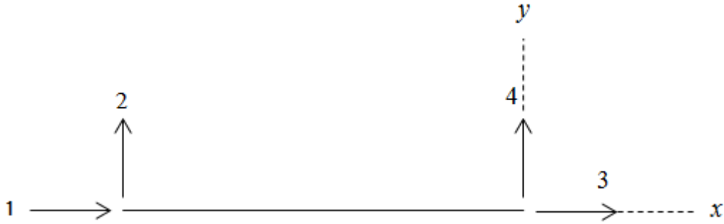
Şekil 3.4. Düzlem kafes elemanın serbestlik dereceleri
