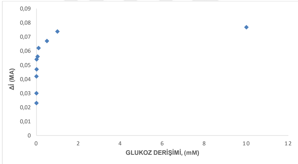
Şekil 4.18. Biyosensörün amperometrik cevabına glukoz derişiminin etkisi (0,1 M pH=7,5 fosfat tamponu, 25°C)
