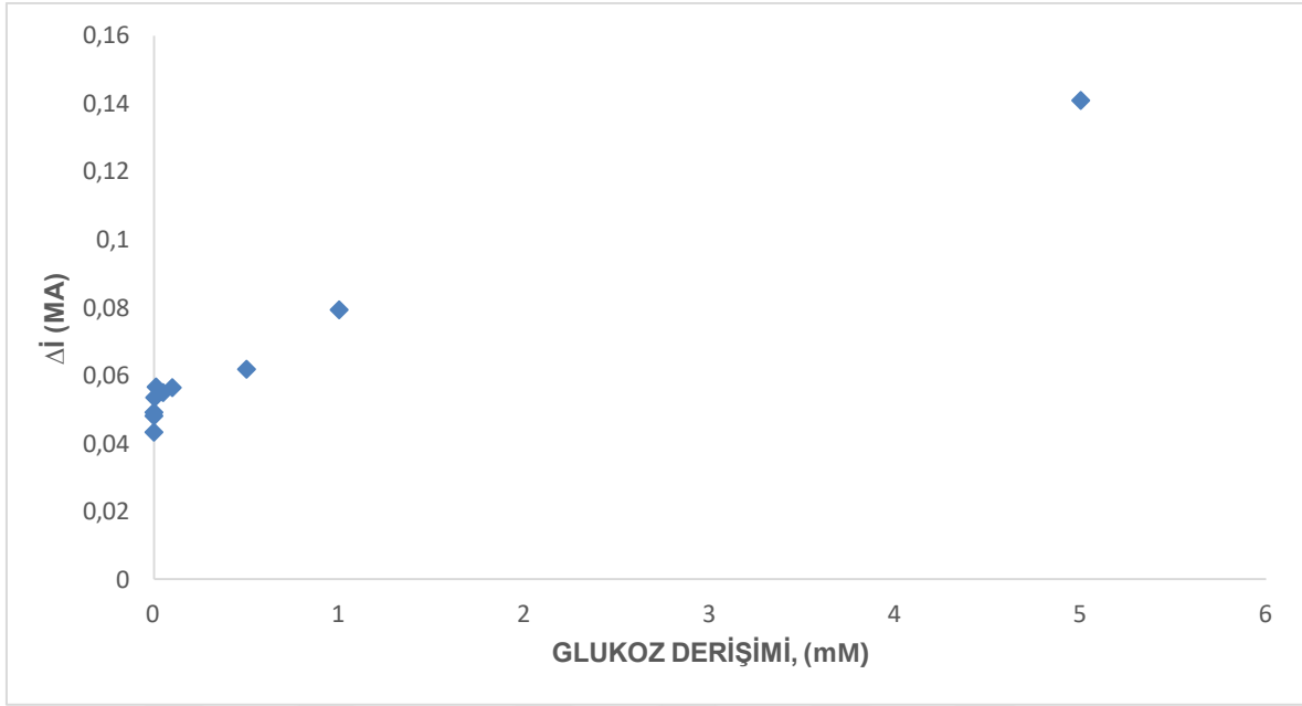
Şekil 4.9. Biyosensörün glukoz duyarlılığı (pH=7,0 fosfat tamponu, 25 °C)
