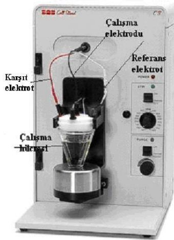
Şekil 3.1. Kaplama ve ölçümde kullanılan hücre sistemi
