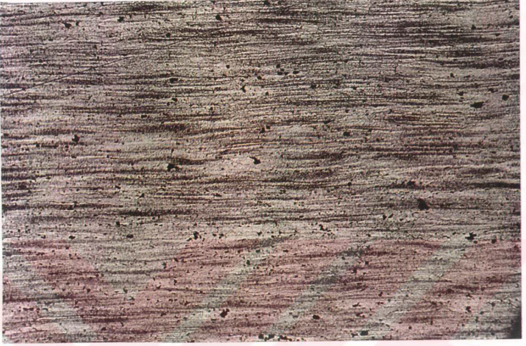
Şekil 6.6. 7039 Al alaşımında ana malzeme mikro yapısı(x100)
