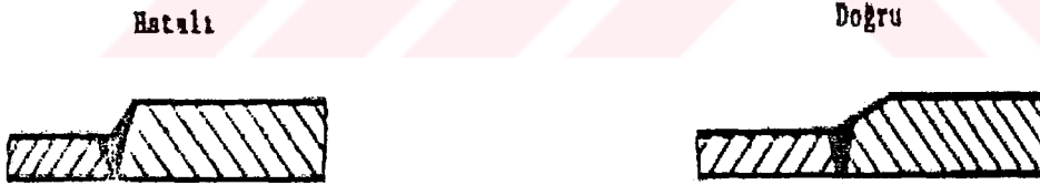
Şekil 4.20. Kesit değişmesi durumu (Bengisu, 1991)
