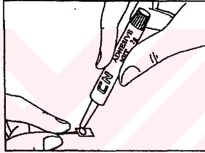
Şekil 5.6. Yüzeye yapıştırıcı uygulanışı (TML kataloğu, 2000)
