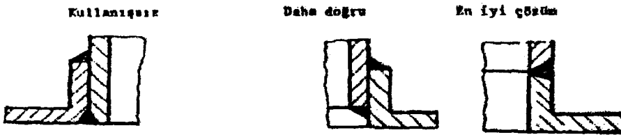
Şekil 4.11. Kaynak dikişinin köşeden içeriye alınması (Bengisu, 1991)
