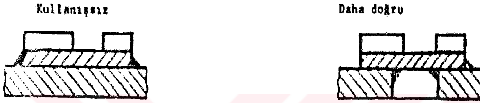
Şekil 4.19. Deformasyonun önlenmesi (Bengisu, 1991)
