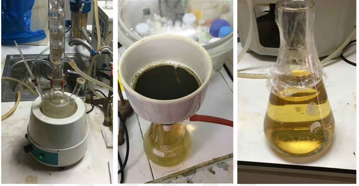
(a) (b) (c) Şekil 3.4: 1100 °C’de elde edilen pirinç kabuğu külü numunesinin sodyum hidroksit ile geri soğutucuda 4 saat ısıtılması (a), vakum altında süzülmesi (b) ve elde edilen sodyum silikat çözelti numunesi (c).
