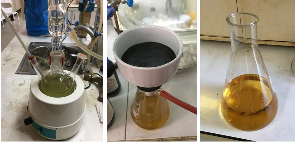
(a) (b) (c) Şekil 3.3: 700 °C'de elde edilen pirinç kabuğu külü numunesinin sodyum hidroksit ile geri soğutucuda 4 saat ısıtılması (a), vakum altında süzülmesi (b) ve elde edilen sodyum silikat çözelti numunesi (c).
