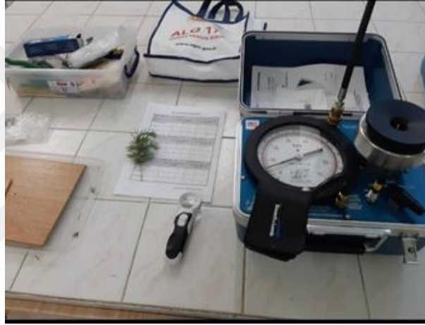
Şekil 3.8 Scholander basınç cihazının genel görünümü
