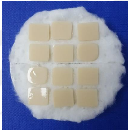
Resim 3.22. Petek Kristalizasyon Tepsisi Üzerinde Fibröz Ped ile Desteklenerek Glaze Fırınlamasına Hazırlanmış Kristalize LDS Seramik Örnekler
