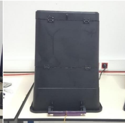
Resim 3.49. Ölçümler Esnasında Kapağı Kapatılan Karanlık Kutu Düzeneği
