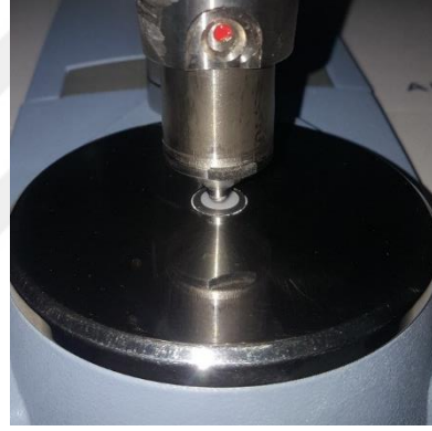
Resim 3.48. Numuneyi Elmas ATR İle Tam Temasa Getirmek Üzere Kapatılan Press
