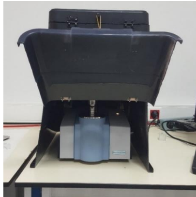
Resim 3.49. Ölçümler Esnasında Kapağı Kapatılan Karanlık Kutu Düzeneği
