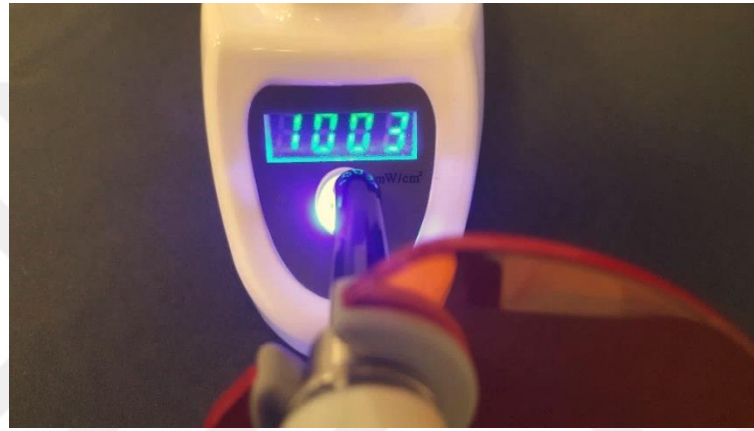
Resim 3.41. Işık Şiddeti 1000 (\pm 200) \text{ mW/cm}^2 değerindeki LED Işık Kaynağı
