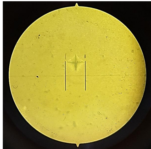
Resim 3.53. Yük Uygulamasından Sonra Rezin Siman Örneğin Mikroskop Görüntüsü
