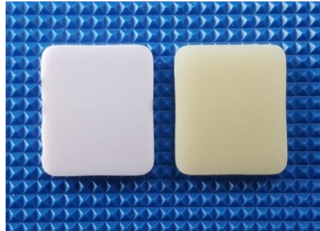
Resim 3.20. Kristalizasyon Öncesi ve Sonrası e.max Örnekler
