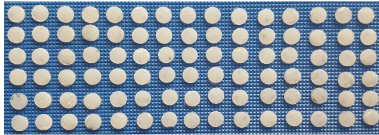
Resim 3.44. Mikrosertlik Ölçümü İçin Hazırlanan 1 mm Kalınlığa Sahip Rezin Siman Örnekler
