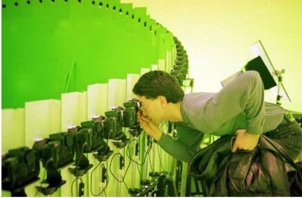
Görsel 14: Flow motion tekniği için fotoğraf makinalarının dizilişi.
