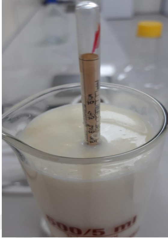
Şekil 3.7. Süt örneğinin yoğunluk analizi.
