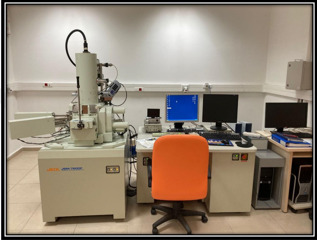
Şekil 3.4. JEOL JSM-7600 F model Taramalı Elektron Mikroskobu (SEM)
