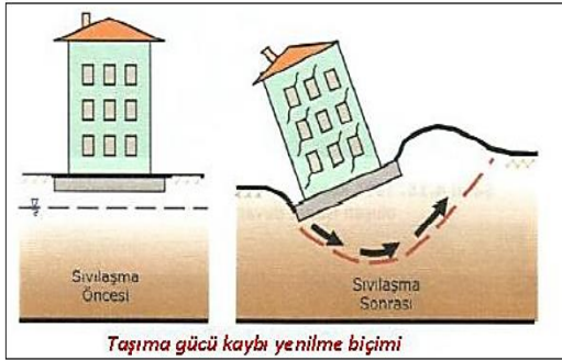
Şekil 2.26. Taşıma gücü kaybı oluşum şeması (Doğan, 2015).
