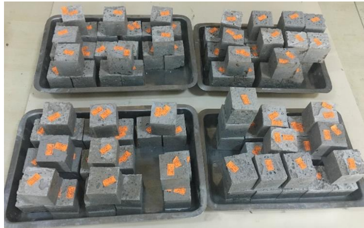
Şekil 5.11. Üretilen harç numuneleri
