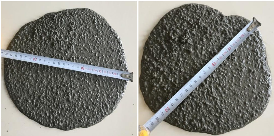
Şekil 5.9. Mini çökme-yayılma deneyi
