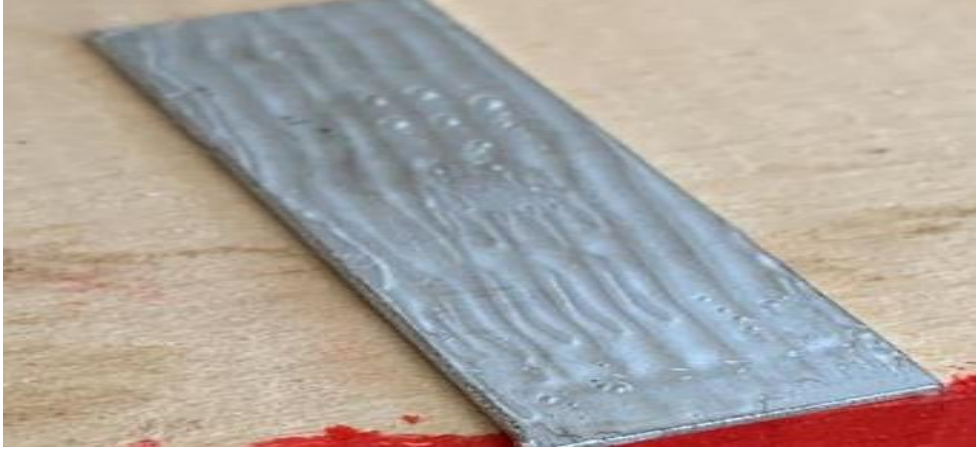
Şekil 2.2 Yapıştırıcının yapışma yüzeyine uygulanması.
