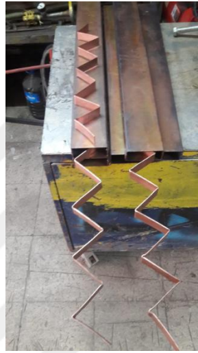
Şekil 3.25: Isı transferi için kullanılan zig-zag bakır şeritler.
