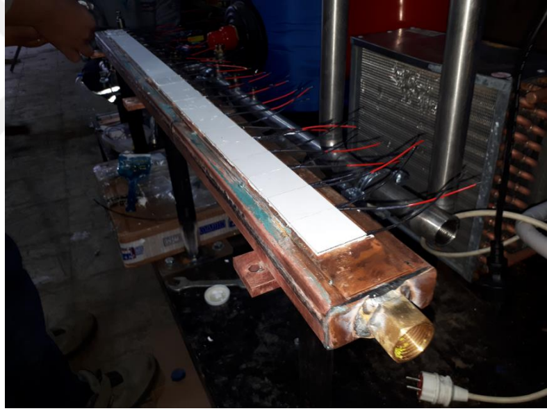
Şekil 3.29: TEG'lerin soğuk su taşıyan bakır profil üzerine yerleştirilmesi.
