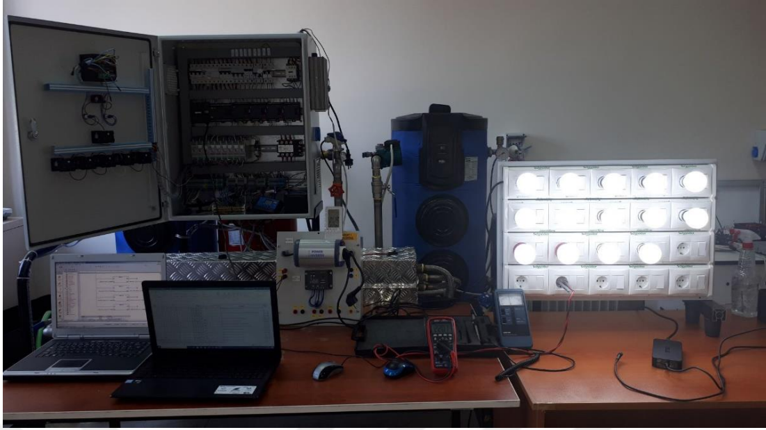
Şekil 4.10: TEG sisteminde AC yüklerin enerjilendirilmesi.
