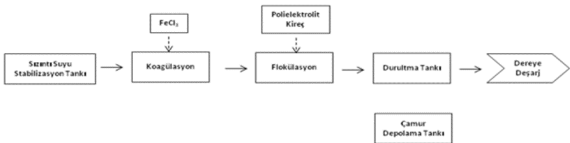
Şekil 2.8. Didim Sızıntı Suyu Arıtma Tesisi akım şeması (Öztürk ve ark., 2010)
