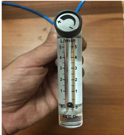
Şekil 5.14. Gaz akışının ölçülmesi için kullanılan ayarlı debimetre.
