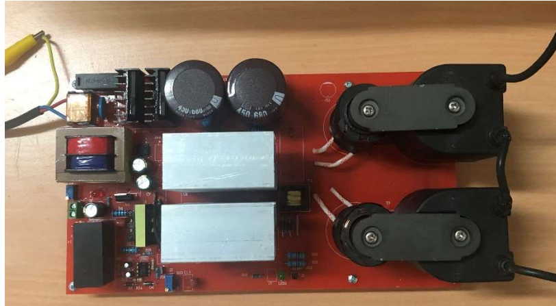
Şekil 5.8. Plazmanın oluşturulması için kullanılan güç kaynağı ünitesi.
