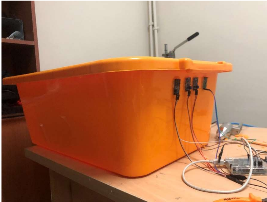
Şekil 5.3. Gaz sensörlerinin proses odasına monte edilmiş görüntüsü.
