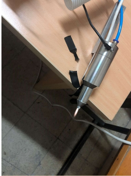
Şekil 5.5. Plazma kaleminin aktif durumdaki görüntüsü ve plazma oluşumu.
