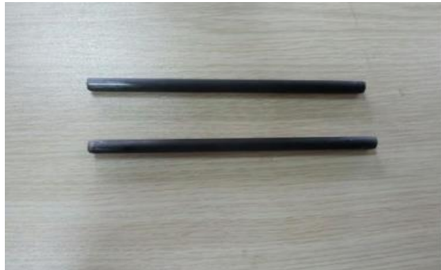
Şekil 3.2. Karbon bazlı elektrotlar (Öztürk, 2018)
