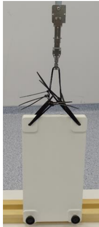
Şekil 4.3: Yük altında gerinim gevşeme test düzeneği
