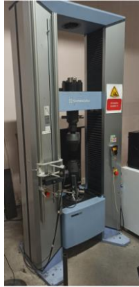
Şekil 5.1: Shimadzu AGS-X 250kN basma-çekme sistemi
